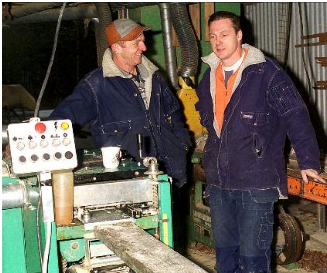
Thomas Petersson och svärsonen Mats Kruse vid en av Kallinge Plåt & Byggmateriäls två fyrkutteriga Logosol-hyvlar. Med två hyvelmaskiner kan de jobba parallellt och hyvla fler sorters lister snabbare.
