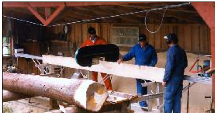
Ingvar Allm och hans söner vid sågverket i Dalsland. De har ordnat sin arbetsplats föredömligt, med ett såghus och ett enkelt stockbord för att underlätta hanteringen. Läs mer i reportaget på mittuppslaget
