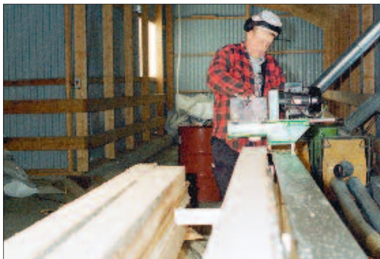
Sven Hjelm har just bytt sågaggregatet mot timmerfräsen och justerar stålen. Han är en av dem som testat Logosols prototyp.
