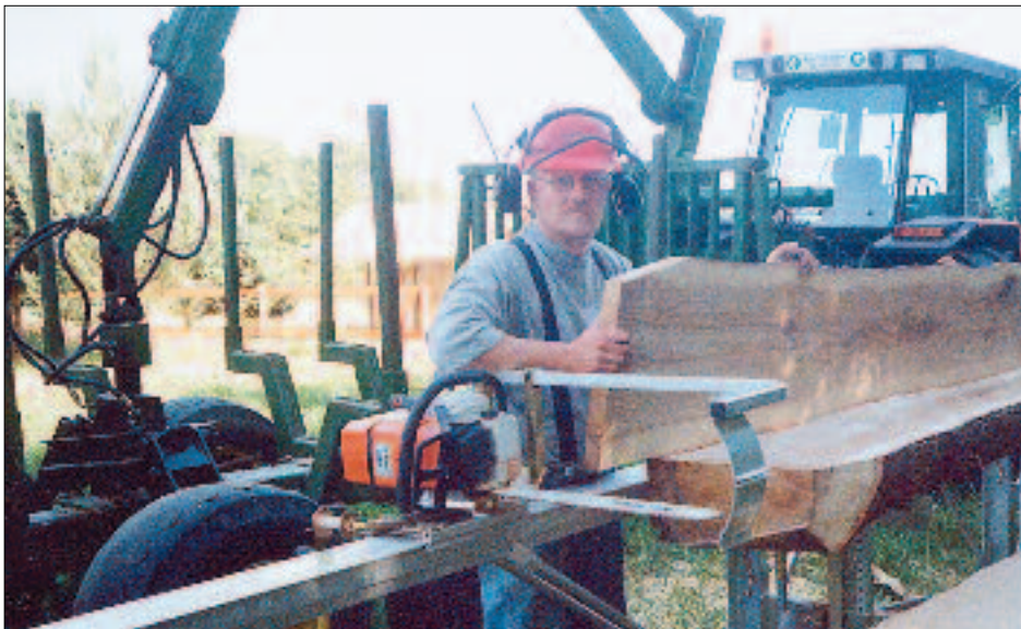
Solosaven klarer let en hård egetræsstamme. Her har Erik Sørensen netop forvandlet en egestamme til kostbart møbeltræ. Af en stamme med en diameter på ca. 50 cm og en længde på 320 cm. Blev der 6 stk 2" palnker. Købspris ved en dansk tømmerhandel: ca. kr. 800,- pr. stk. Da egetræ i denne dimension ofte havner som brænde var købsprisen for stammen kun kr. 220,-, så fortjenesten ved et eventuelt salg er til at få øje på.
