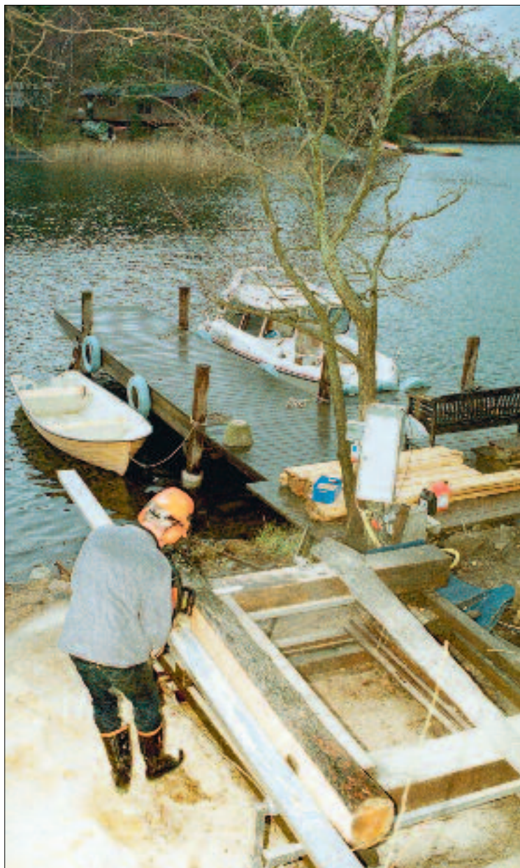
Ove Hammarström har monterat sin djungelsåg på en båtslip och spelar ned sågverket i vattnet för att hämta stockarna.
