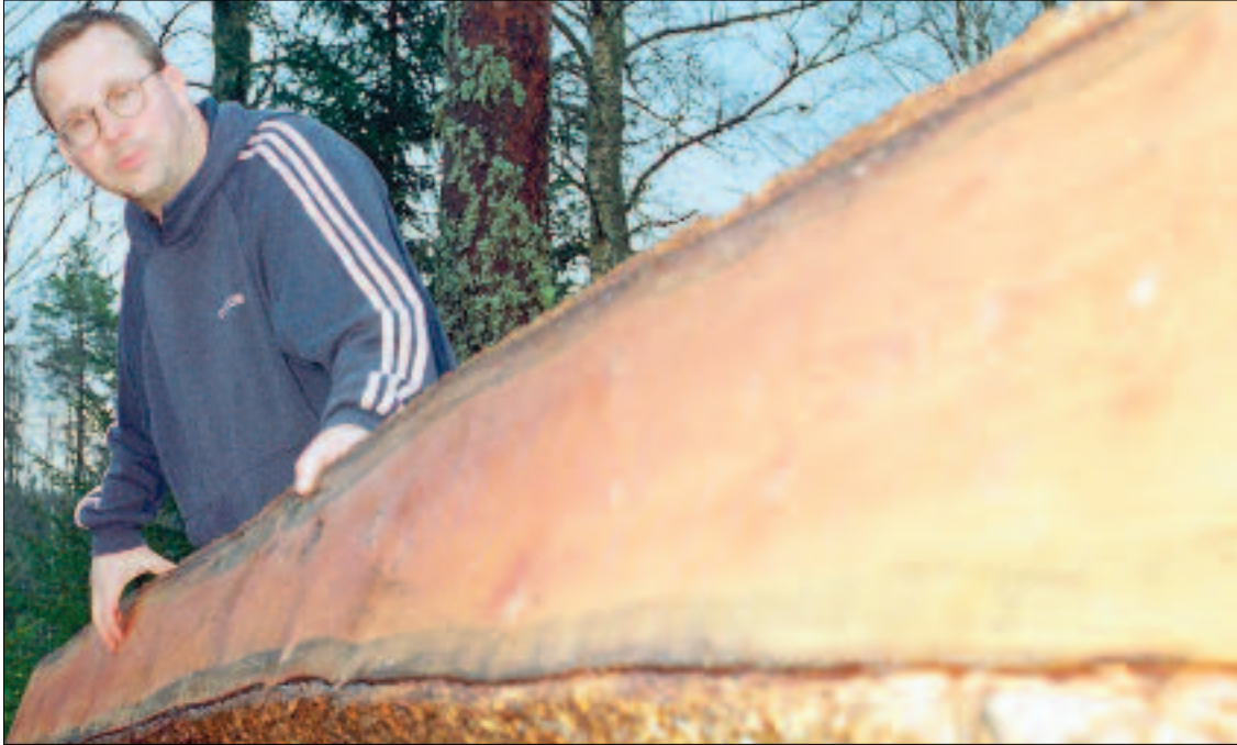
– Den här brädan har legat utomhus hela året. Kärnveden har inte påverkats det minsta, säger Per-Erik Sjögren, tidigare produktionschef på ett sågverk, som med Solosågens hjälp undersöker lärkens egenskaper.
