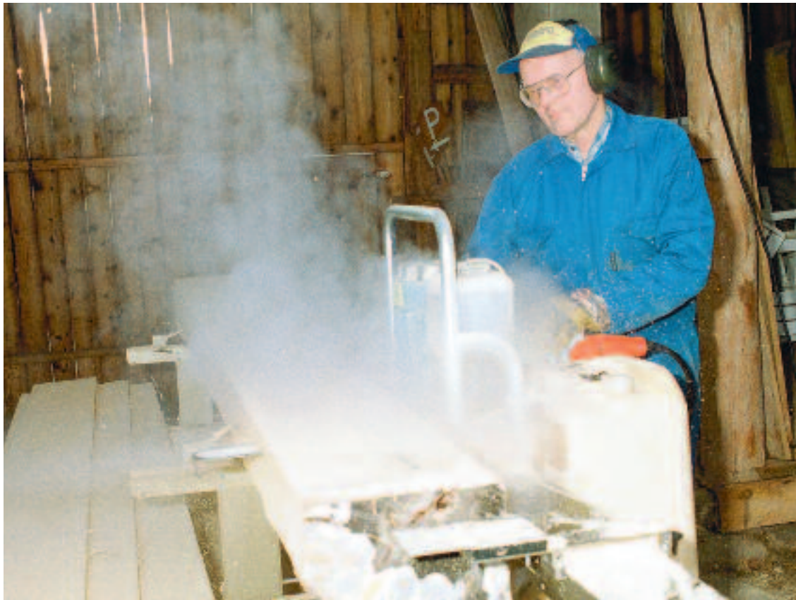
Erik Johansson sågar den första stocken på en av de första levererade Solosågarna modell 7. Stocken är rejält sur och röken är vattenånga. Men resultatet blir bra och Erik, som haft Solosåg tidigare, är mycket nöjd med nyförvärvet.
