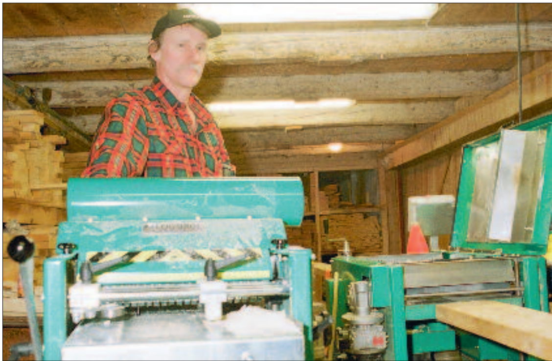
"Blandbrukaren" Bertil Petersson ger Solohyveln klart godkänt. Han konstaterar att den innehåller ungefär samma komponenter som den stora 4-kutterhyveln, fast i färre antal. Det borgar för en hållbar och lättservad hyvelmaskin
