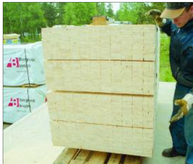
Det blir varken skägg eller sprickor i ändarna när hela virkespaketet kapas på en gång.
