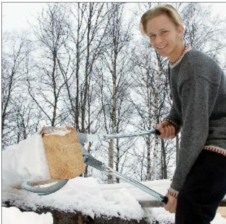
Konstruktören Mattias Byström visar hur den patenterade stocklyftaren fungerar. Ena griparmen hindrar stocken från att rulla tillbaks, medan den andra vänder stocken åt rätt håll.
