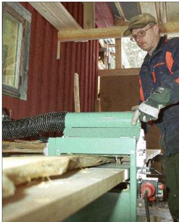
– Solohyvelns enda kutter klarar nästan alla typer av lister, säger Jan Fritzson som har satt maskinen på hårda prov.
