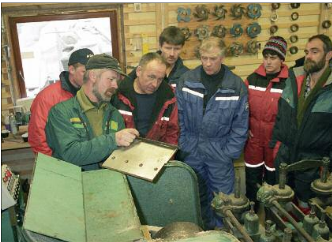
Skolans industrihyvel väger sex ton, har sex kutterar och hyvlar över 100 meter list i minuten. Ändå föredrar eleverna Logosols PH 260, som används parallellt under utbildningen.
