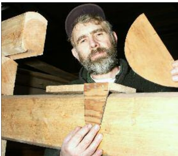
Roger Fagerberg tillverkar knutarna snabbt med egenutvecklade mallar.
