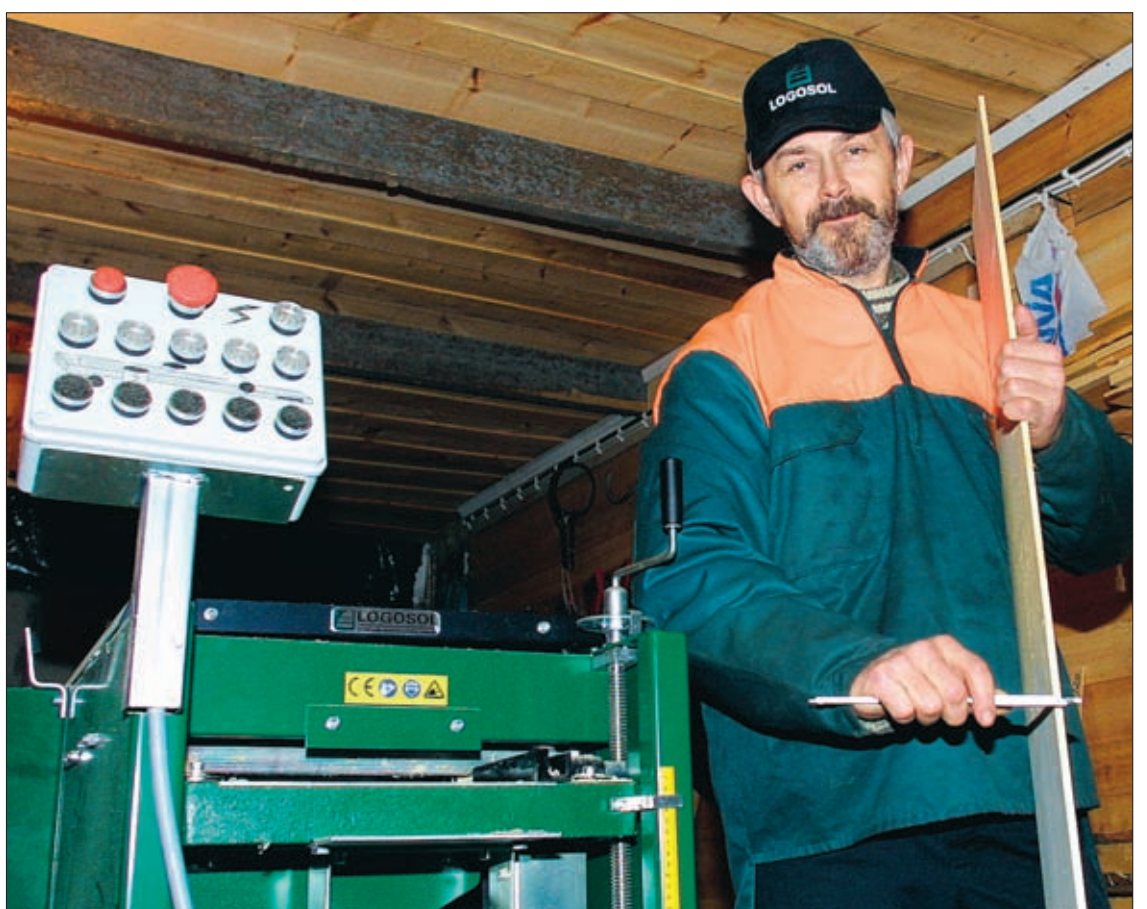
– Logosol byggde om panelhyveln så att jag kan hyvla det tunna virke som krävs för syltlådorna, säger Jan-Erik Sorsén.
