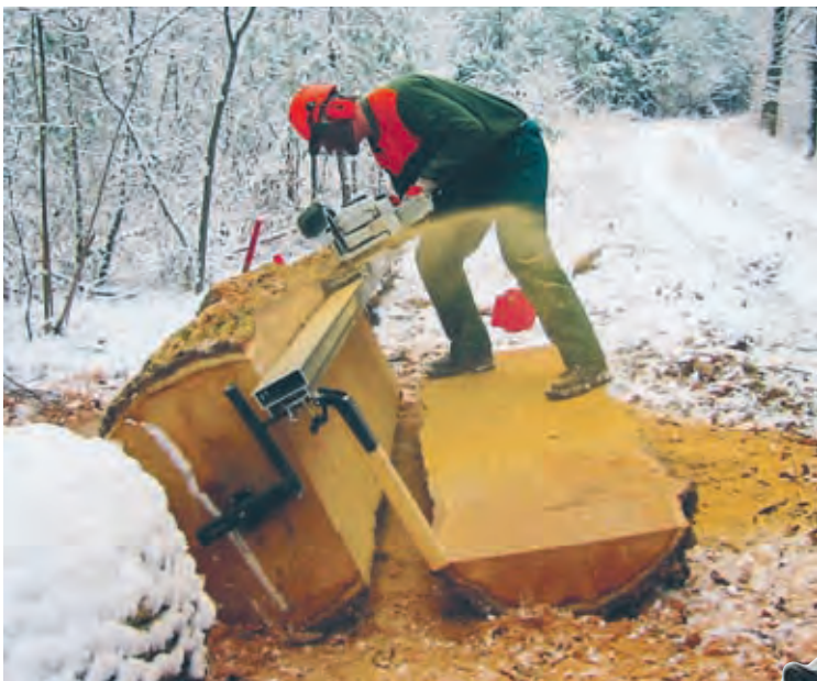
Timmerjiggen med Big Mill-utrustning provkörs i Tyskland.
