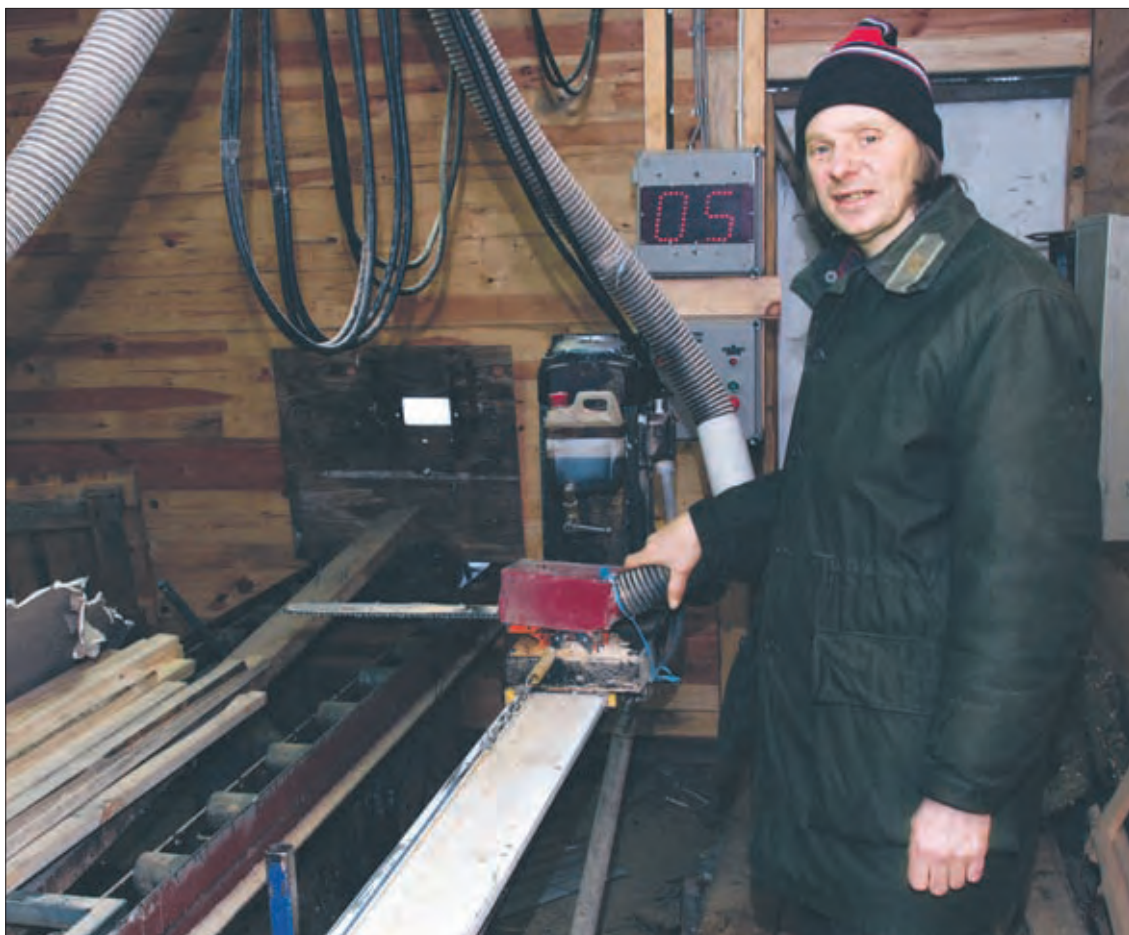
Ronny Thörn med sitt egenhändigt byggda sågverk. Det är byggt av stål med Solosågen som förebild och väger över 300 kg.
