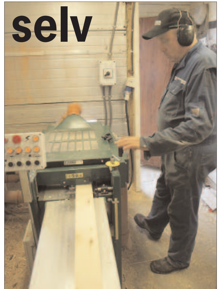
— Dersom vi arbeider begge to, kan vi klare 10-20 meter per minutt med høvelen, forteller Bjørn Westby.
