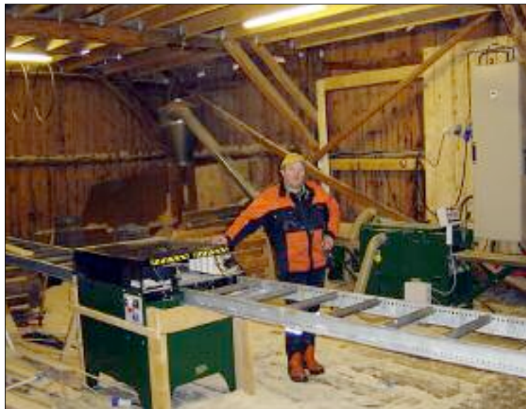
– Klyvsaga er helt perfekt til å klyve planken på høykant til akkurat den dimensjonen som er mest egnet til hver enkelt profilerte list og panel, sier Øystein Espelund.
