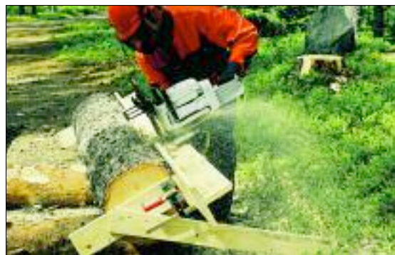
Timmerjiggen är grunden för Big Mill. Du kan köpa bara den och bygga linjal och hållare själv.
