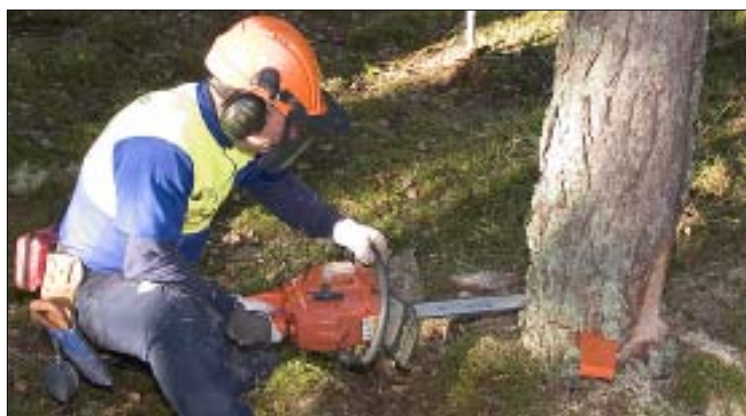
Slutligen sågas säkerhetsklacken av. Trädet ska normalt falla efter det här, annars slår man in kilen ytterligare.
