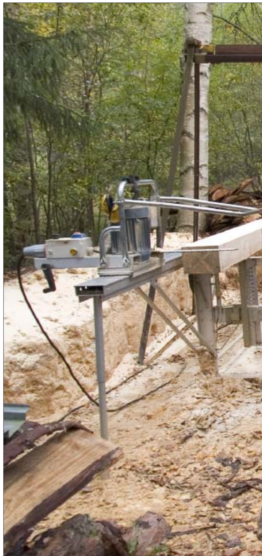
Bo Malmberg arbetar som produktionsteknisk chef på Electrolux i Motala. tänkt. Stockarna anländer på spåret till höger. Sedan lyfts de till solosågen på vagnen till vänster, för vidare transport till torkning.
