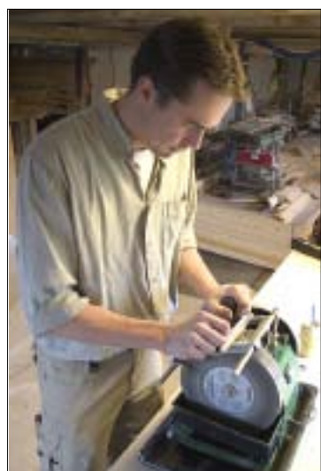
– Det är rätt kul också att slipa stålen själv, säger Roger Björk- lund, här i färd med att skärpa ett profilstål.
