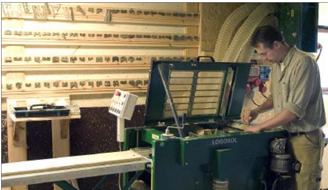
Enligt Roger Björklund är det viktigaste för ett bra hyvlingresultat högklassigt virke och skarpa stål. Skärpan ordnar han själv med Tormeks slipmaskin och jiggas för profil- och planstål.
