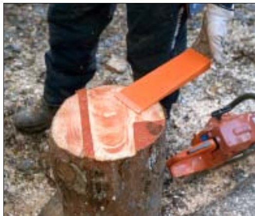
Så här ska snittet se ut, med ett lagom brett gångjärn och en säkerhetsklack.
