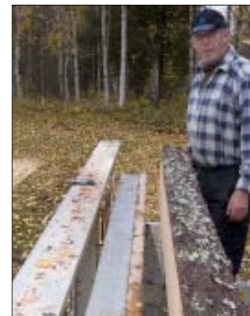
Linjal med sidoanläggning stödjer och håller fast tunna block.
