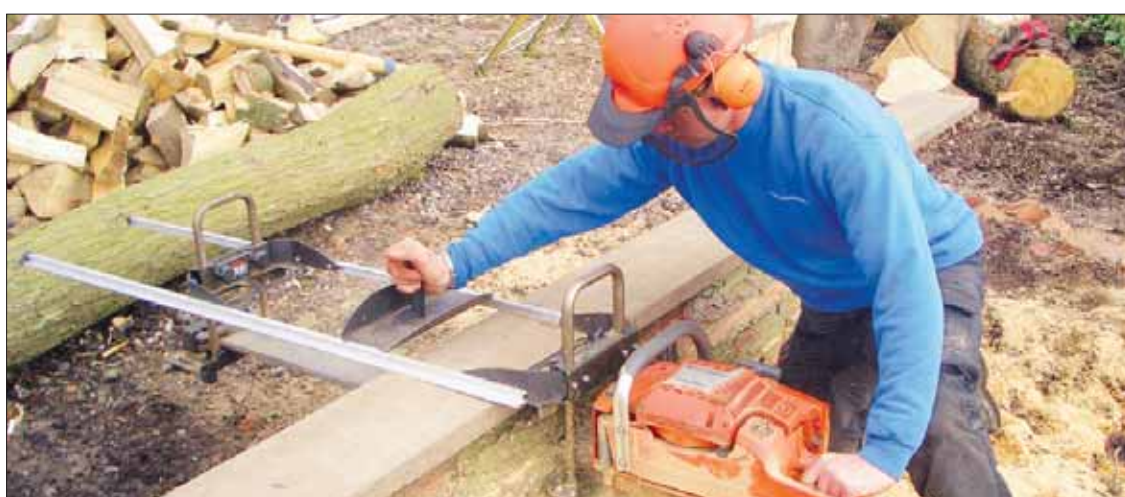
Logosol Big Mill är ett system som gör att du monterar ihop rätt sågverk för varje uppgift.
