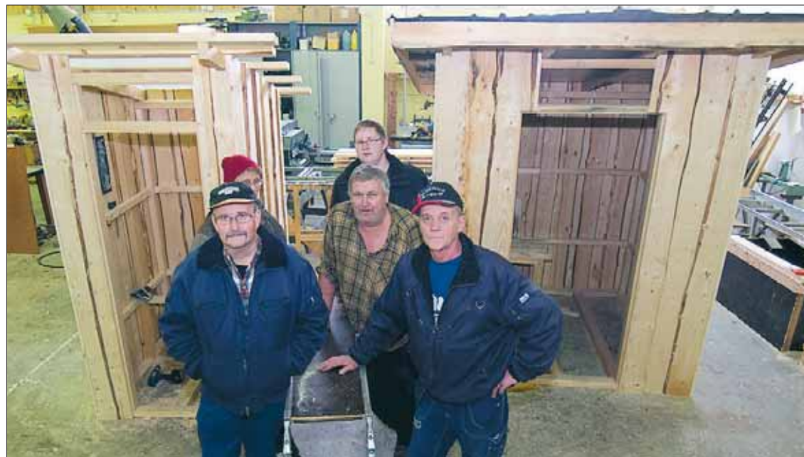
Snickeriet drivs av Sollefteå kommun. Här tillverkas allt av virke som sågats på en Solosåg. Under den här vintern byggs utedass och vindskydd av okantat virke, även kallat vildmarkspanel.
