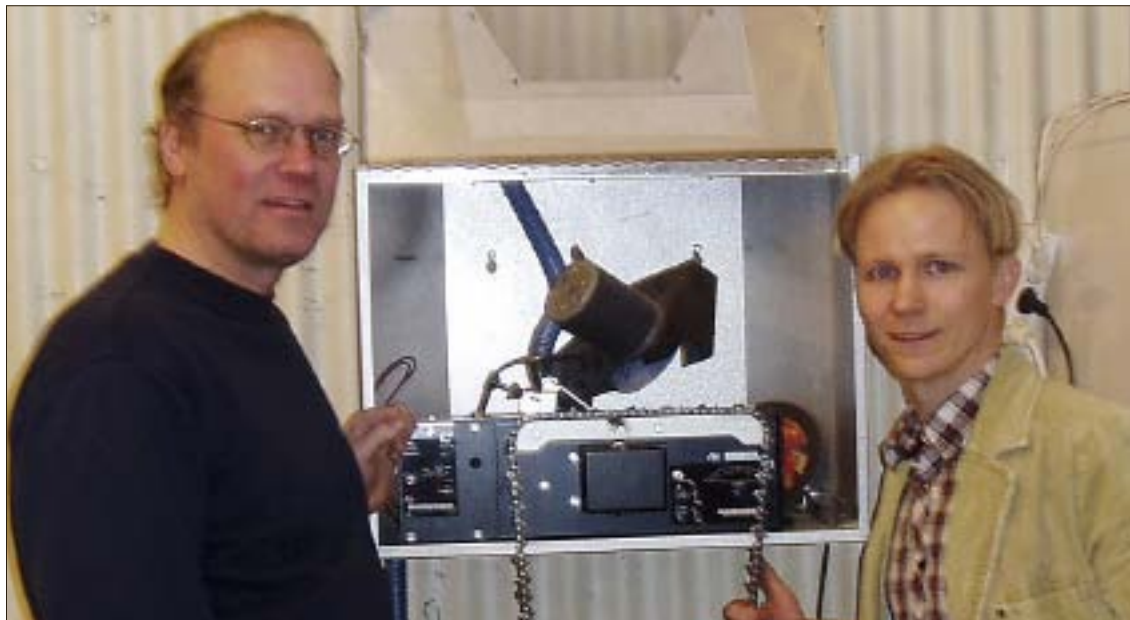
– Skivan ska justeras före varje slipning oavsett vilken slipmaskin man har, säger Pär Markusson(t v) som konstruerat Logosols sliprobot tillsammans med Mattias Byström.
