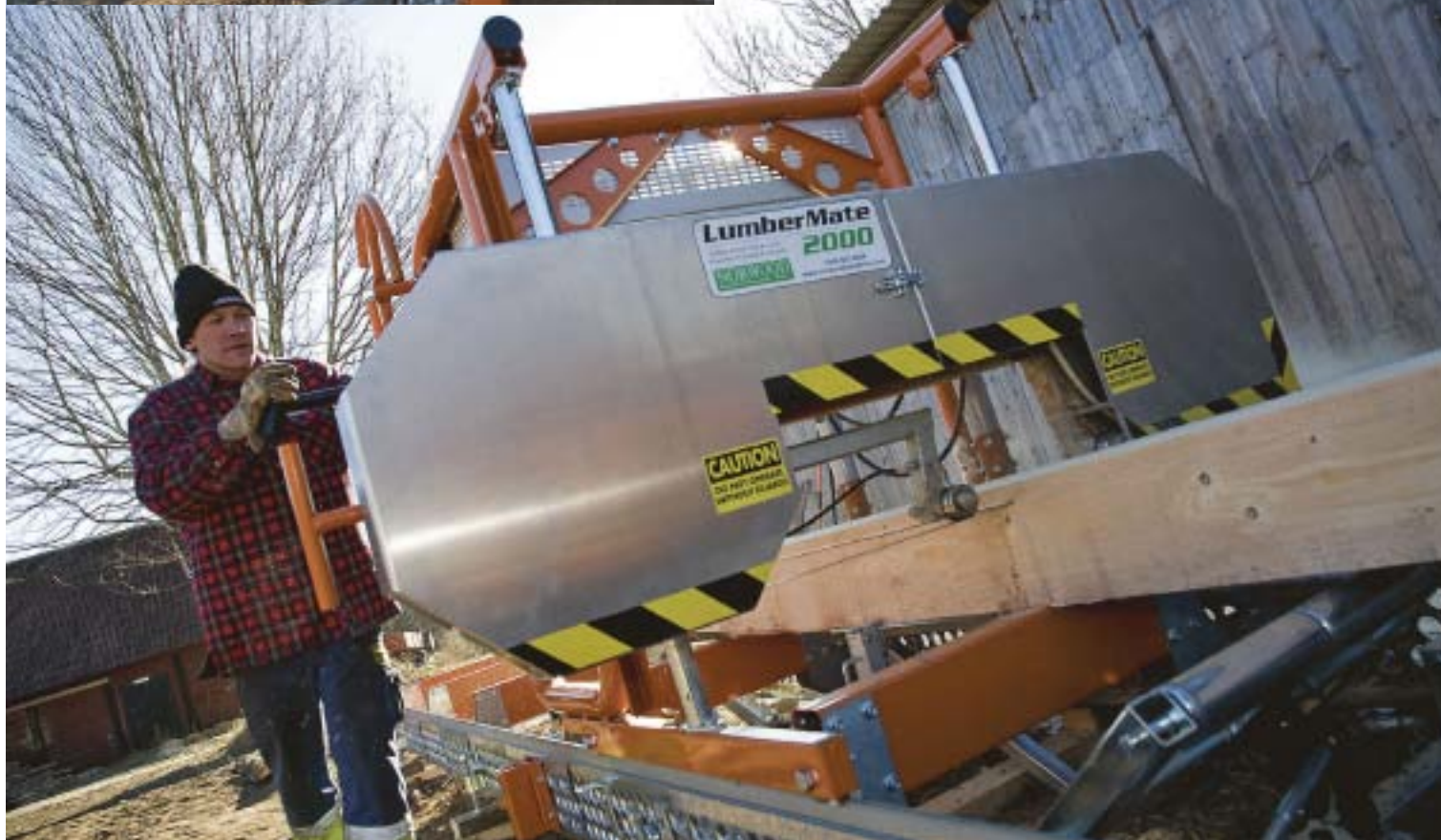
– En enkel och stabil konstruktion, är Jörgen Dahlskogs omdöme om Logosol LM40. Stocklastaren på den övre bilden är ett tillbehör som underlättar hanteringen av grova stockar.
