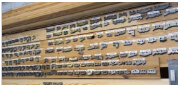
Delar av stålsortimentet för hyvleriets 170 profiler,
