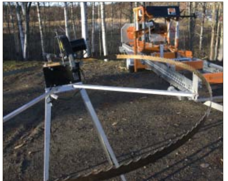
Logosol Grindlux slipar sågbladen perfekt och klarar även att slipa ur tandbottarna.
