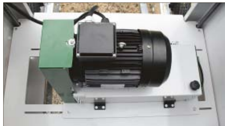
Hela motorpaketet med kutter kan förskjutas i sidled, vilket ger en hyvelbredd på 600 mm.
