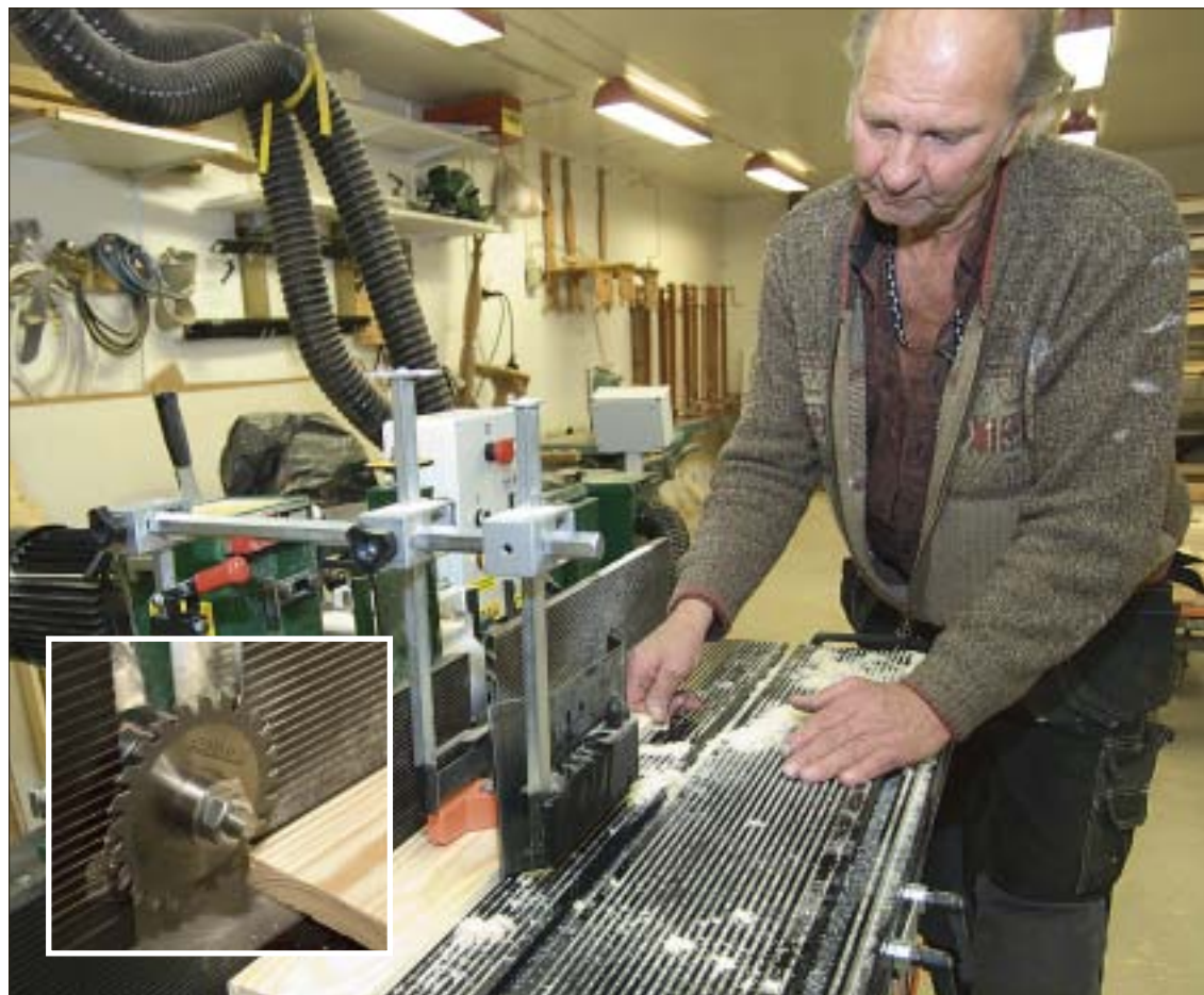
Sten-Gustav sågar fram spåret i lådsidorna med Logosols vertikalfärs MF30. Den infällda bilden visar sågklingan, Spindeln kan vridas 180 grader.
