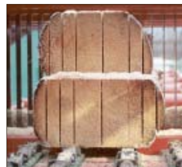
Ramen med upp till 20 sågblad gör Låksågen så snabb.
