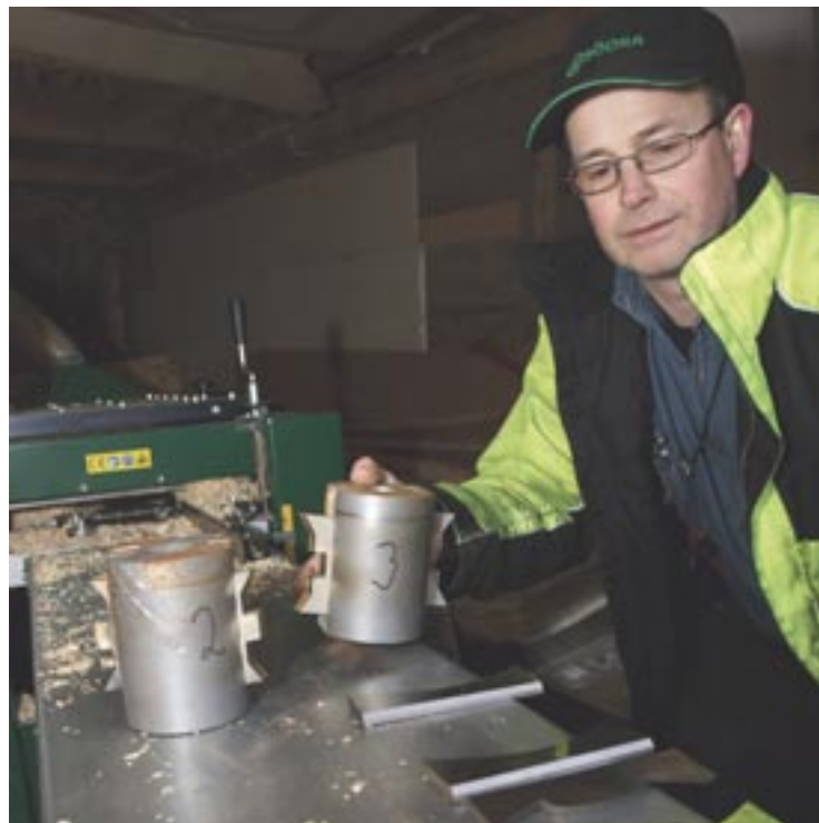
Spindelförlängare gör att Lars Rytberg kan använda stora räffelkutrare med rejäla stål för hyvling av timmer i sin Logosol PH260.
