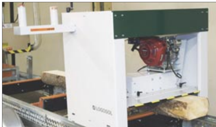
Nu finns Logosol LM410 även med bensinmotor. Det är samma kraftfulla timmerfräs och balkhyvel som elversionen, för dig som jobbar där elnätet inte når. Passar även för andra fabrikat av stockbandsågar.
