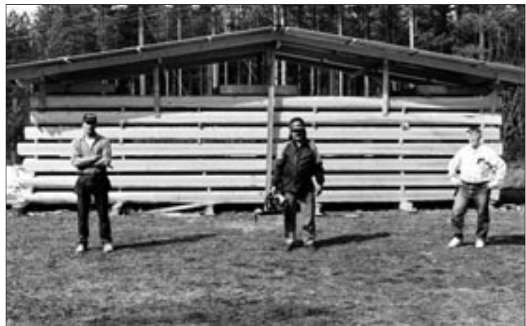
En bild från 1993, efter att 52 tio meter långa balkar hade sågats med två sammankopplade solosågar.
