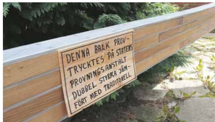
Limträbalk av alm och aluminium har dubbla styrkan.
