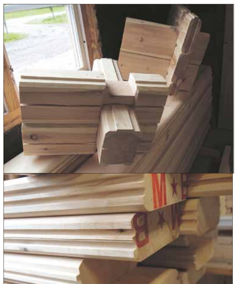
Stommen i produktionen är en Logosol PH260. Med den har Åke Stålberg hyvlat 50 000 löpmeter. Av det är 10 000 meter 3-tumstimmer, med en egen profil, syns till höger. Ovan syns ett exempel på det 5-tumstimmer som tillverkas med Solosåg och Timmerfräs.
