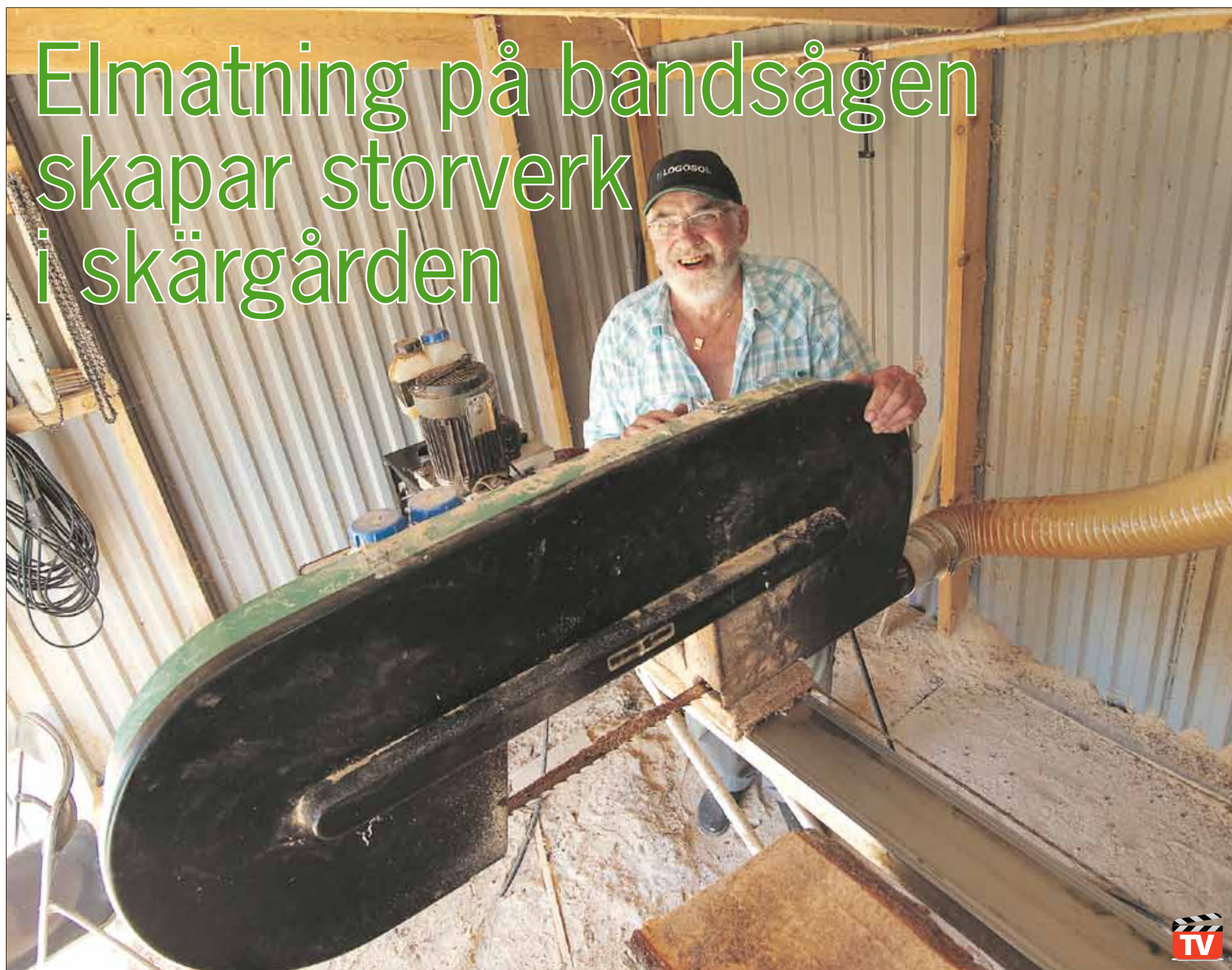
Rolf Palmqvist i S:t Anna skärgård sågar så mycket att det snabba bandsågsaggregatet inte var snabbt nog. Han monterade på fästet som används på elsågar och timmerfräsar för att få matning på bandsågen. Det fungerar perfekt.
