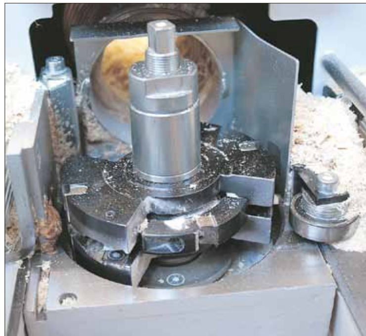
Specialverktyg för spontning, tillverkade av en verktygsmakare i Italien, till priset av en fjärdedels hyvelmaskin.
