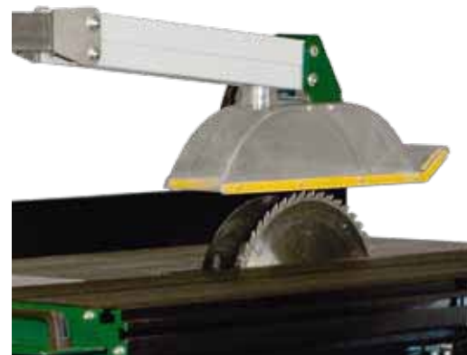
Logosols formatsåg PS 315 levereras bara med SUVA-skydd. Det kostar en slant men är det säkraste skyddet.
