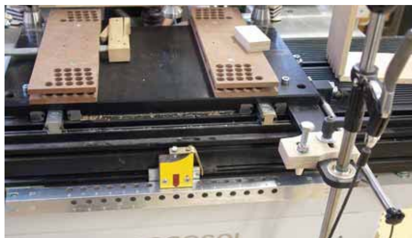
Delningsskena för XY-bord. Låsning med handbroms. (Nedan)
