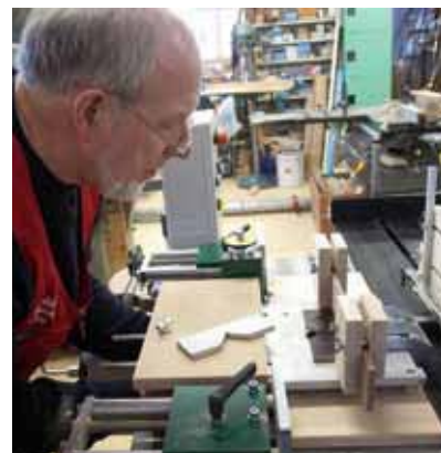
Anhåll för pinnfräsning från undersidan. Nedan resultatet.
