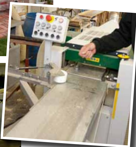
En smart stödrulle utanför hyveln hjälper till att styra virket genom maskinen.
