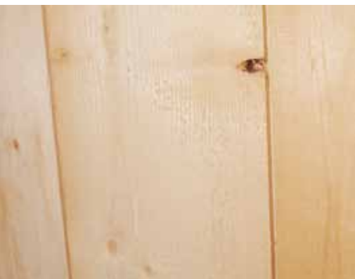
Luddig bandsågad bräda omgiven av släta kedjesågade.
