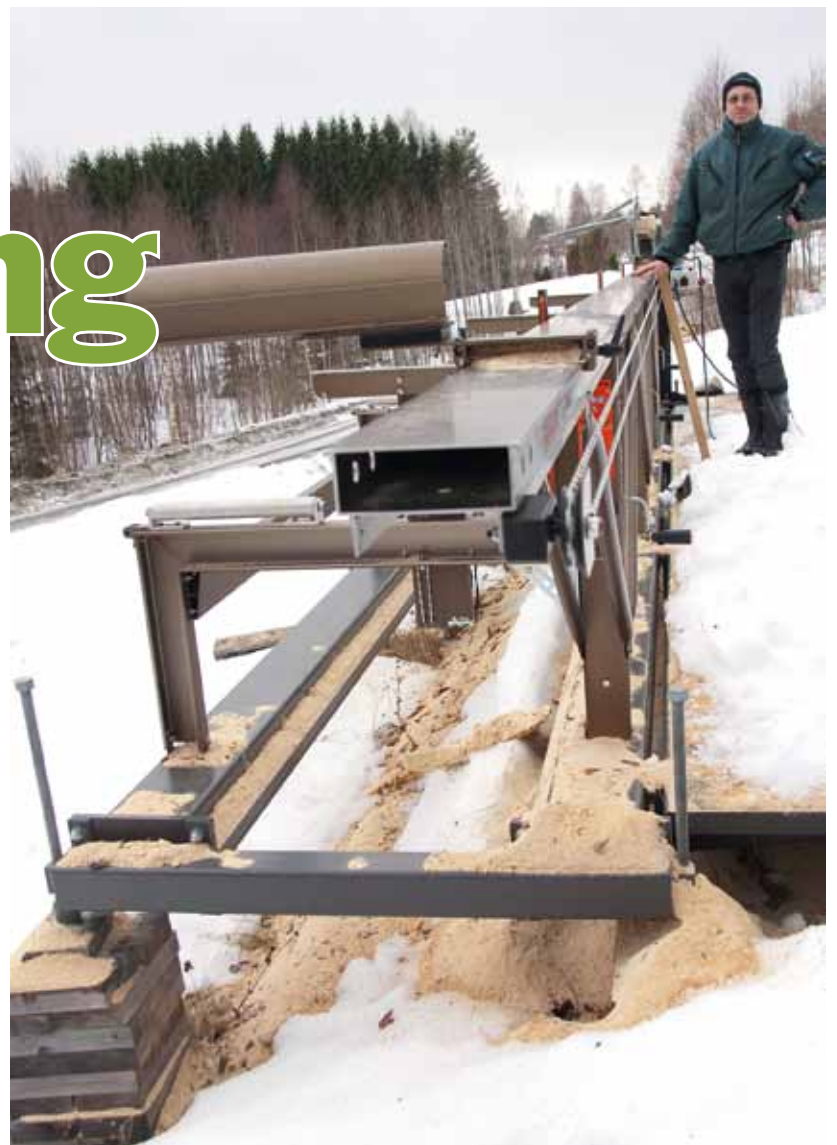
Spikrakt och varenda vinkel injusterad på hundradelen. Mats Kristoffersson har byggt en flyttbar stålram för sin Solosåg. Resultatet blir extrem precision oavsett vad eller var han sågar.
