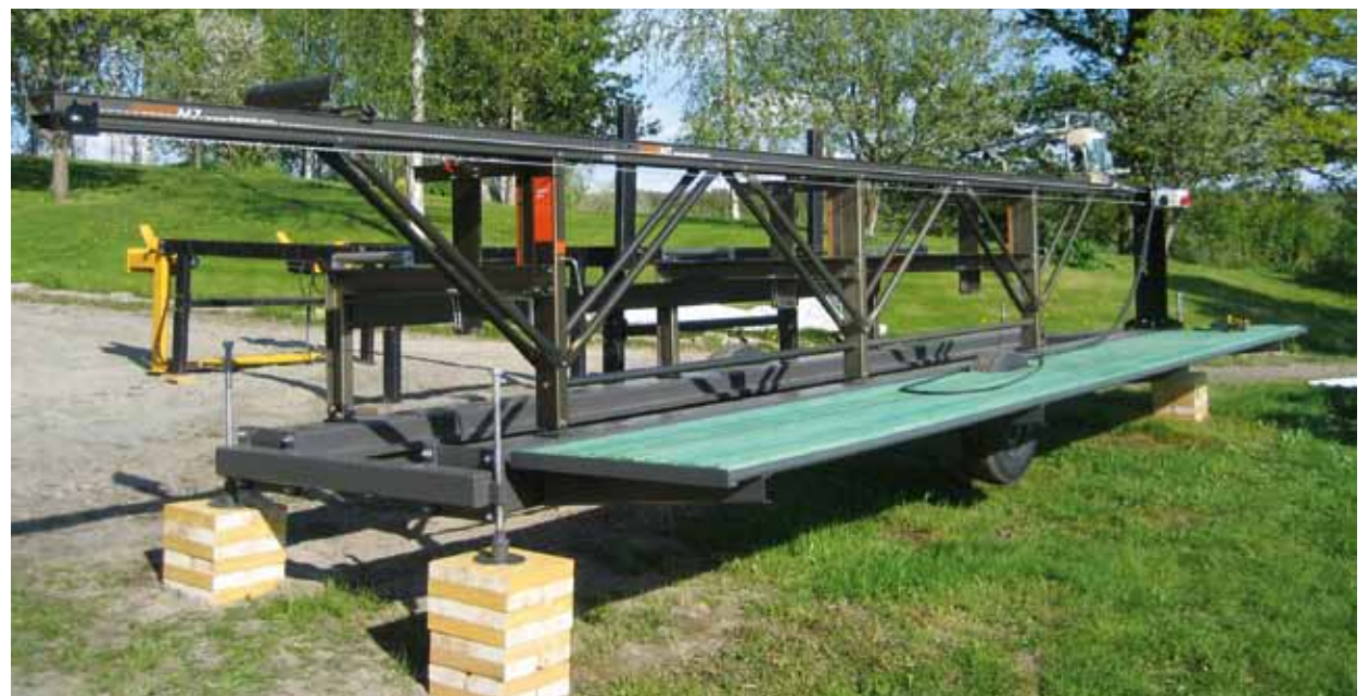
Såverket i sommarskrud, när det just blivit färdigt. Landgången på sidan är uppfällbar för att hela anläggningen smidigt ska kunna flyttas med traktor.
