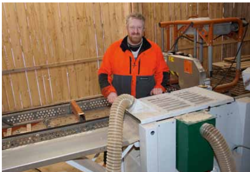
Hjärtat i verksamheten är två maskiner från Logosol, bandsågverket LM40 och fyrkutterhyveln PH260.
