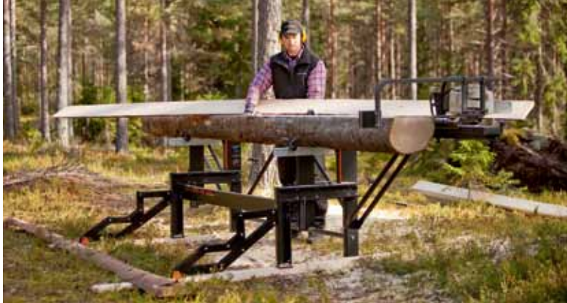
• Stocktrapporna är numera integrerade i Solosågen.
