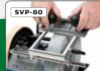
Jigg för profilstål
