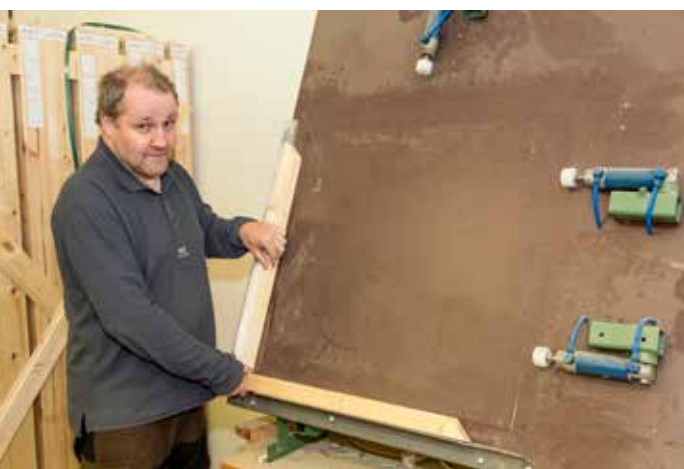
• Stig Eriksson demonstrerar stationen för montering av fönsterglas.
