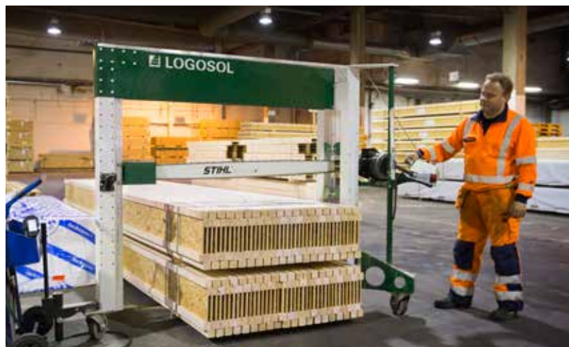
• Enkelt och smidigt, intygar operatören Hans-Erik Högländer om paketkapen som används för att exaktkapa balkar till främst hustillverkare. Paketkapen är en maskin som uppfyller våra högt ställda krav på noggrannhet och kapacitet.
