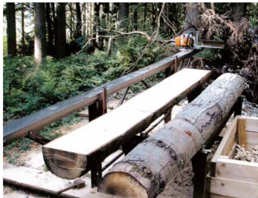
• Uppställning med egenbyggt stockbord i trä. Det var när Grant Meadows sökte på Internet som han hittade lösningen han behövde på Logosols hemsida. Med Solosågen kan han förverkliga sina drömmar om träförädling.
