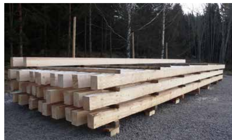
• Resultatet är travar med färdigsågade bjälkar av massivt timmer, upp till 15 meter långa.
