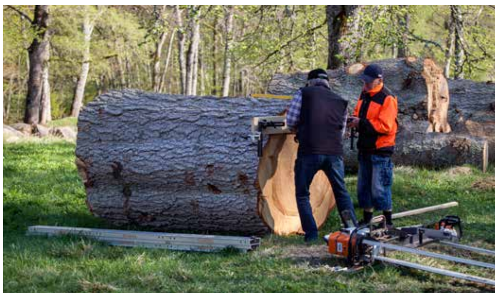
• Två sammankopplade timmerjiggas monterades på jättestocken med ett 1,5 meters svärd och sedan var det bara att börja såga rejäla plankskivor.
