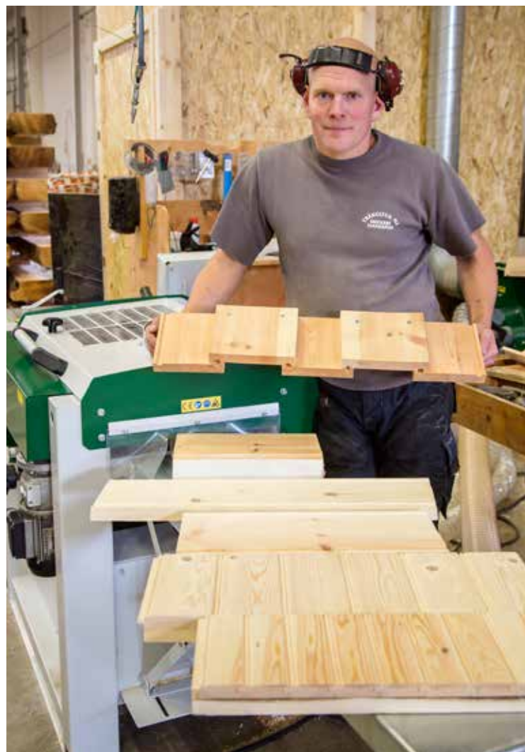
• En fyrkutterhyvel PH260 ingår i maskinparken. "Det blir lite panel och pärlspont, och ibland beställningar med korta serier och då beställer jag specialstål från Logosol", berättar Marcus Lindgren.
