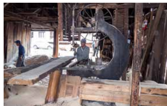
• Logosol besökte ett lokalt sågverk i Bhutan som sågade stor stockar med en gigantisk bandsåg. Bilden till höger visar en klyvsåg för kantning av plank på fri hand. "Obefintligt arbetskydd, med svenska mått mätt", kommenterar Bengt-Olov Byström.
