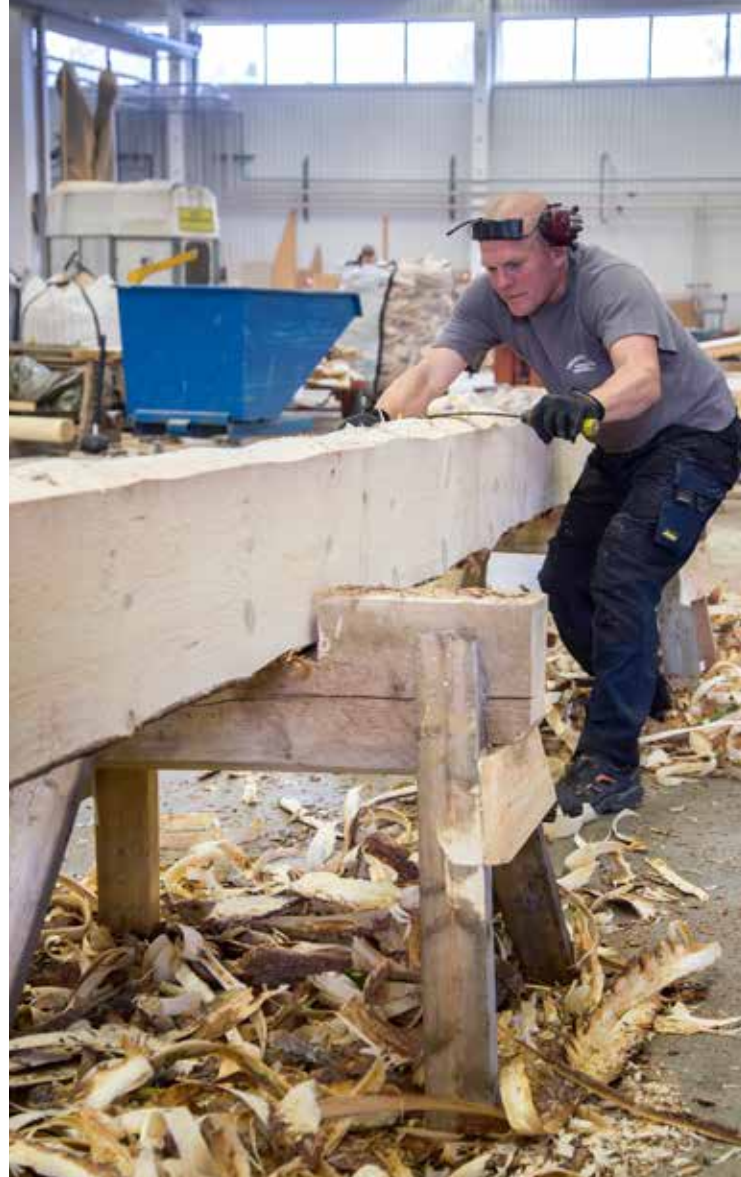
• Timmermannen Marcus Lindgren arbetar gärna traditionellt. Genom att forma stocken med bandkniv får den färdiga timmerväggen extra karaktär. Gränsfors bandkniv säljs hos Logosol.
