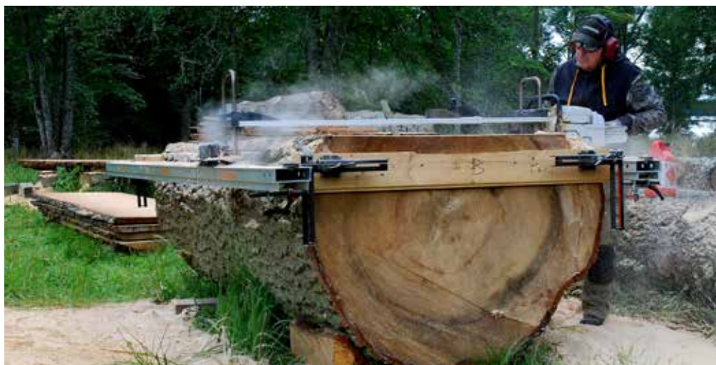
• Under ledning av Arne Hvit fortsatte föreningen att såga upp jättestockarna. Ett 40-tal plankor i storlek 100-140 centimeter breda blev resultatet av deras arbete.
