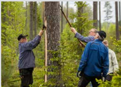
• Ett egentillverkat barkjärn fastsatt på en utdragbar aluminiumstång används för att komma åt tallen.
