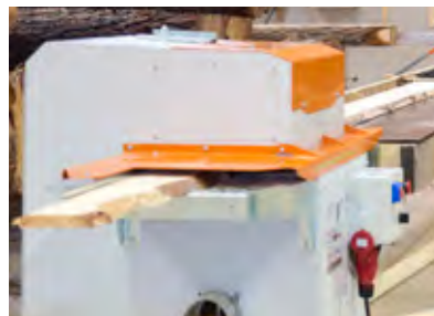
Med ett separat kantverk får sågaren en maskin som effektivt sågar bort kanterna på brädorna.
