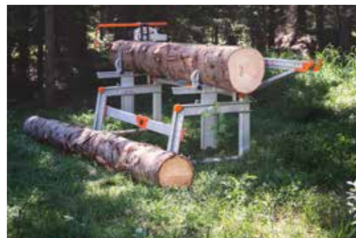
Med F2* sågades stockar upp till fint snickerivirke.
