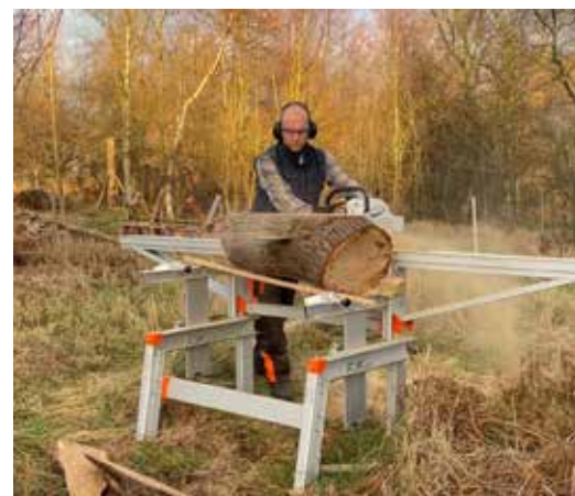
Det geniala med F2+ är dess flexibilitet. Har du kortare stockar kan du lätt korta ner även sågverket.
