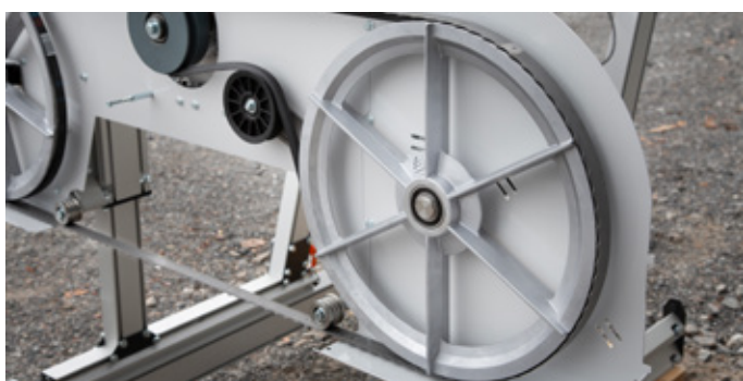
Båndhjul med vifteblader som kjøler ned bladet og holder dekkelet rent.
