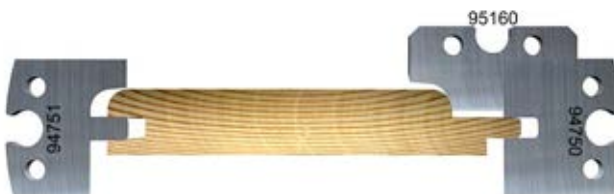
Shadow moulding, round edge
