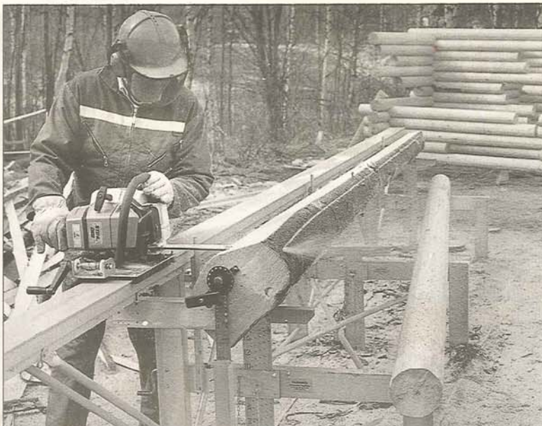
Så här ser timringstillsatsen ut. Med den och en Solosåg blir det enklare att timra.
