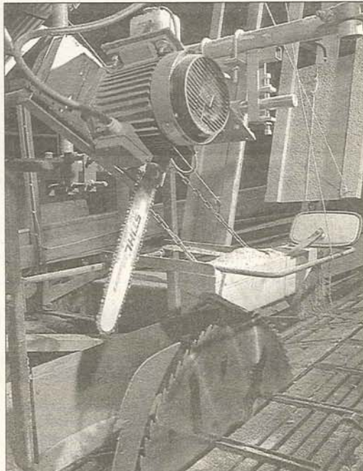
Toppklyven från Logosol ökar kapaciteten i cirkelsågverk och gör det möjligt att såga övergrova stockar
