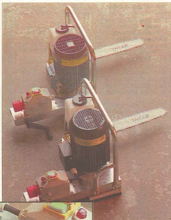
Vägen till effektivare, tystare och billigare sågning heter elsåg. Hos Logosol väljer du mellan två starka trefasssäger. Den största har en specialmotor från ABB på 5 kW.
