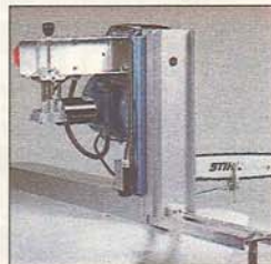
En vikbar linjalbit gör att du snabbt och enkelt får din elsåg i rätt läge för filning av kedjan.
