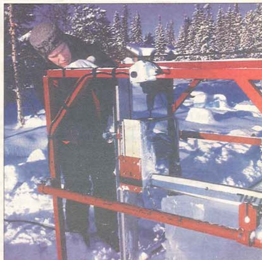
Ishotellet byggs med en rad olika kluriga maskiner av egen konstruktion. Logosols elsåg E5000 för att bygga ett sågverk för isblock. Bilder: La
