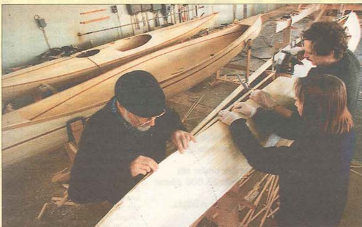
Kanoter och kajaker av trä är inte bara en fråga om utseende. Byggheten med trälistor och glasfiberarmerad epoxy gör att kanoterna blir både lättare och starkare än motsvarande av plast eller aluminium. Bilder: Helena Karlsson.
