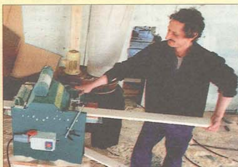
Listverket, en ombyggd Solohyvel, sågar fram 70 meter list per minut och en dags sågning täcker flera veckors arbete hos Wermlandia Kanoter.
