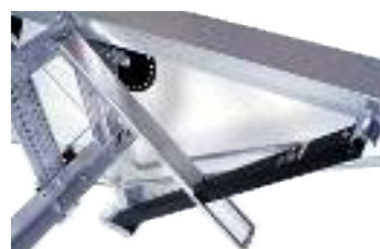
Saxstöd när du vill såga exakt på millimetern ända ute i ändarna av stocken.
