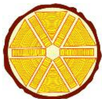
Sågmönstret för den patenterade stjärnsågningen, som forskarna på KTH utvecklat
