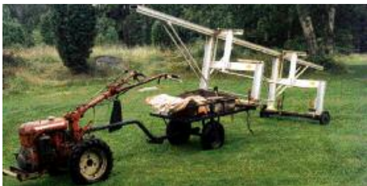
Lennart Pihl i Koda har satt hjul på sin Solosåg och använder jordfräsen som traktor.
