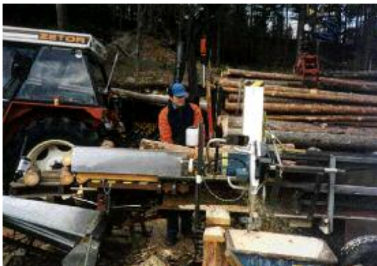
Christer Falk i Valbo har dubbel nytta av sin Logosol E 5000. När den inte gör tjänst på Solosågen använder han sågagget som vedkap. Han har gjort en anordning som utnyttjar traktorns hydraulik för kapning och matning. Hans maskin klyver även veden. Ett snabbt och smidigt sätt att ordna gårdens behov av ved, rapporterar han.
