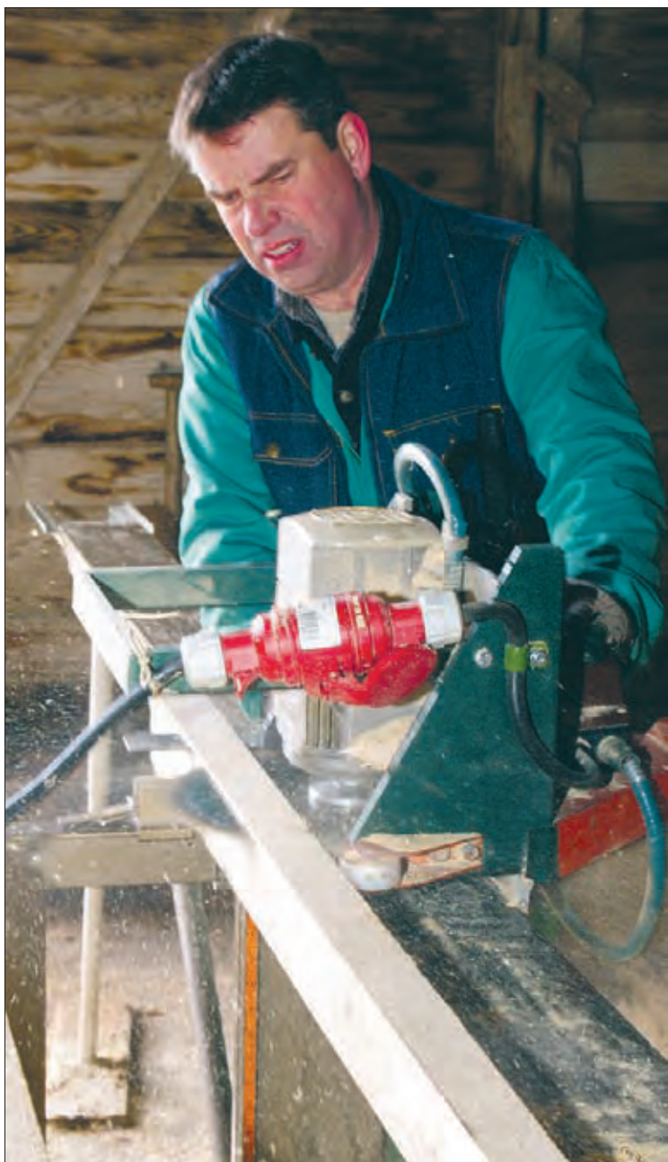
I väntan på en prissvår torrklyv från Logosol, byggde Bertil Wallier en själv med Solosågen som bas. Han använder den mest för att rikta upp torrt virke.
