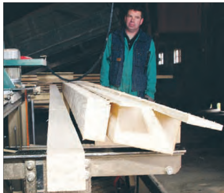
Bertil Wallier klyver fram de dimensioner som kunderna vill ha och tillverkar ämnen för hyvling med sin klyvsåg.
