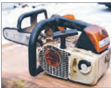
Arborister använder speciella motorsågar, små med handtaget i mitten. Här är Olles arbetsredskap, en Stihl MS 200.
