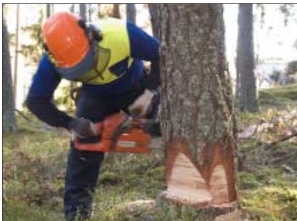
Rensa gärna bort barken från stammens sidor för att tydligt se var snitten hamnar.
