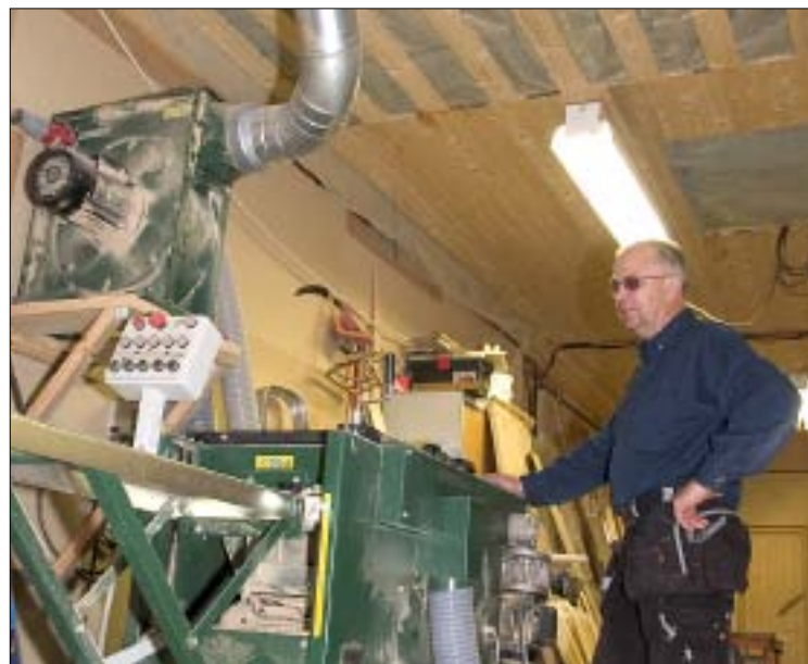
Fyrkutterhyveln är stommen i verksamheten för Gustafssons Bygg AB. Notera lösningen med att blåsa upp kutterspåret på vinden, vilket underlättar spånhanteringen.
