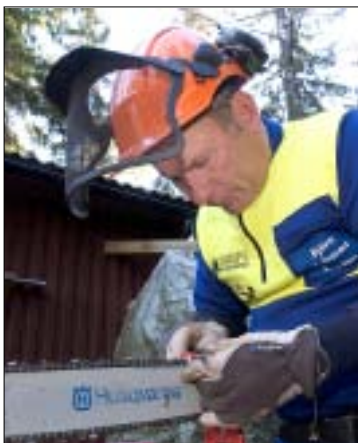
Rätt filad och skarp kedja är ett måste för säker sågning.
