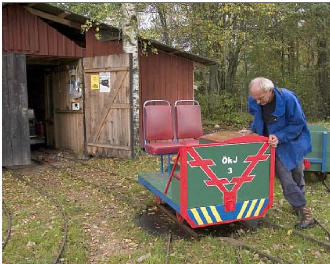
Även små järnvägar kräver en vändskiva. Bakom syns banans lokstall. Loken och vagnarna har Bo Malmberg själv byggt
