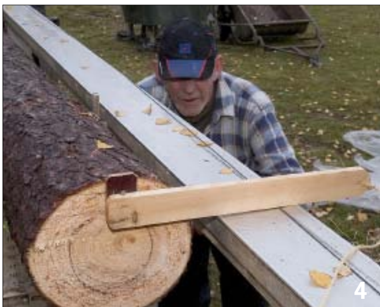
När pinnen är platt mot linjalen, ligger stocken på rätt höjd. Den sitter med en spik i markeringen för sidobrädan.
