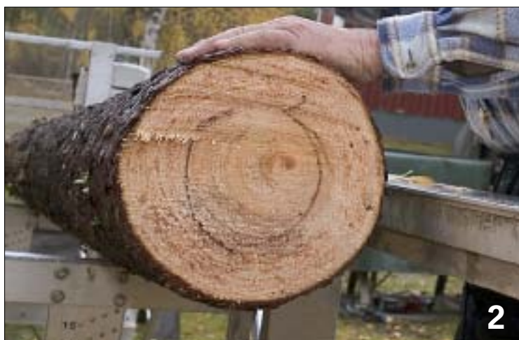
Blockets storlek markeras i båda stockändarna.
