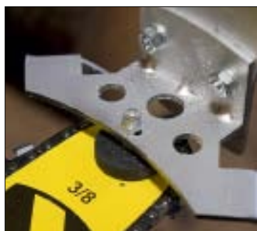
Svärdet hålls fast med en stark magnet i ett justerbart fäste.
