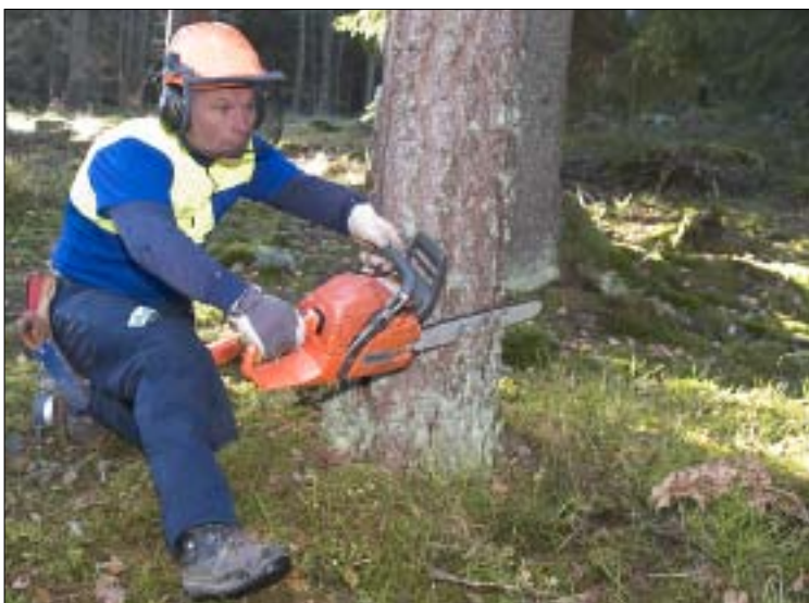
Riktskåret bestämmer åt vilket håll trädet faller. Här gäller det att sikta rätt, så att man säkert vet vart trädet faller och skapa en säker reträttväg.
