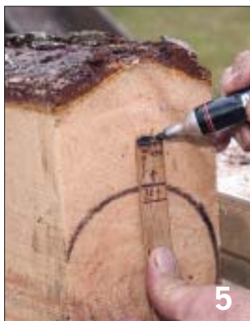
Efter två bakar är sågade markerar den tredje sidobrädan.
