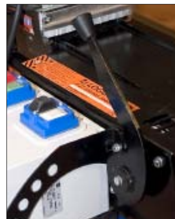
Spaken som reglerar den numera patenterade friktionskopplingen till matningsaggregatet Logosol E37.
