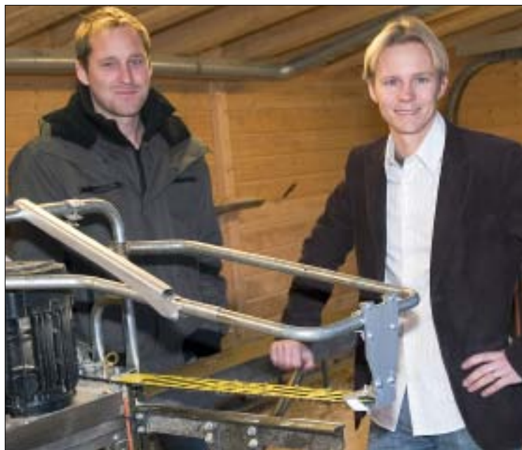
Konstruktörerna Jonas Höglund och Mattias Byström vid elsåg med monterad svärdtoppsstyrning. Skyddsbågen används som fäste för styrningen och stabiliseras med ett stag.
