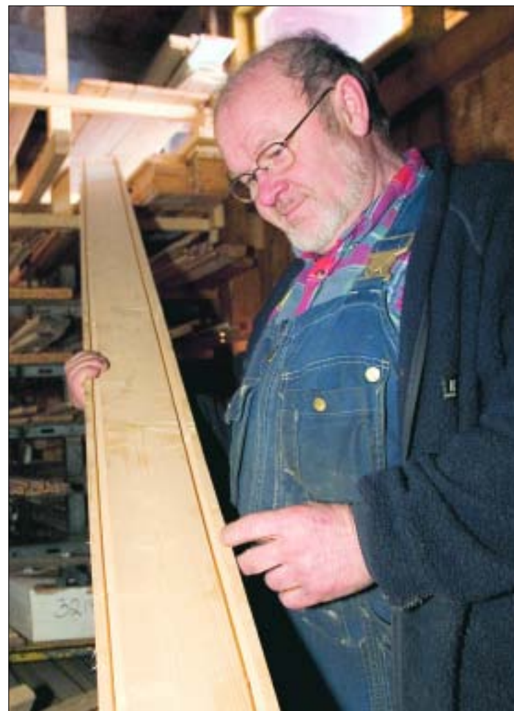
P-O Bergman visar en av sina favoriter, en takpanel med dubbla spår för vattenavrinning. Behandlat med tjära och terpentin blir det ett hållbart tak.
