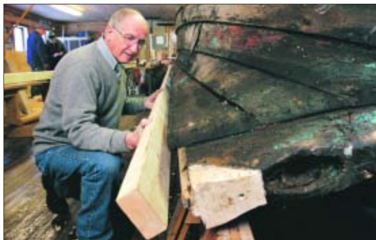
För att byta bottenstock krävs bra virke och duktiga hantverkare. Det första ordnar solosågen, för det andra står bl a Sven-Ove Eriksson och Göran Viklund.
