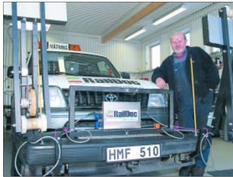
Den specialbyggda bilen som dokumenterar röta i järnvägsslipers har ersatt hyvlingen som jobb för P-O Bergman.
