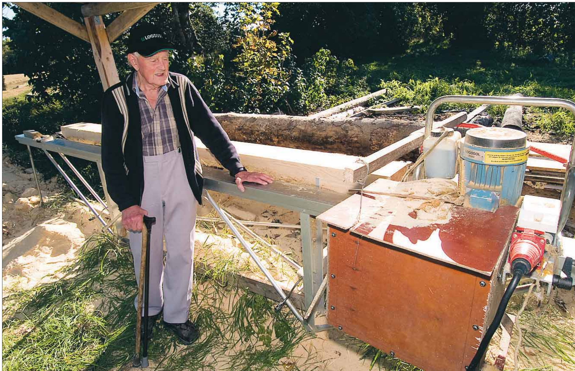
– Det är när man är gammal som man har tid för det som är roligt, säger Bengt Kastensson, 93 år, och fortfarande aktiv vid sitt sågverk. Lådan vid sågaggregatet är en egen konstruktion för att samla in spånet
