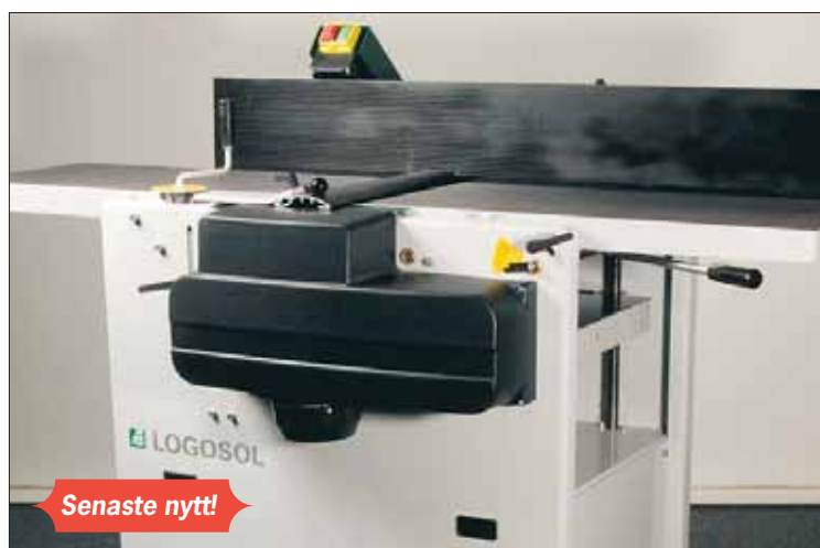
H410 med fasta riktbord som borgar för högsta precision. Den behöver inte byggas om för planhyvling.
