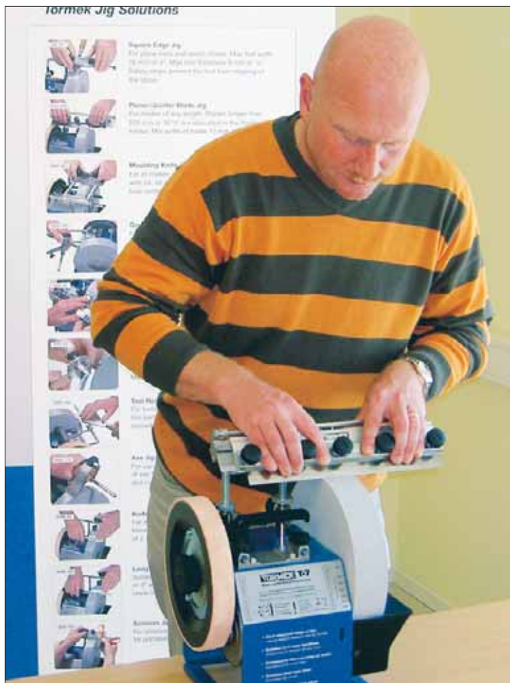
Håkan Persson, vice vd och marknadschef, skärper upp ett maskinhyvelstål med jiggen SVH-320.
