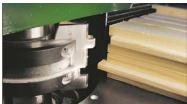
Stålet tar två golvbrädor på en gång, den ena med spont, den andra med not.
