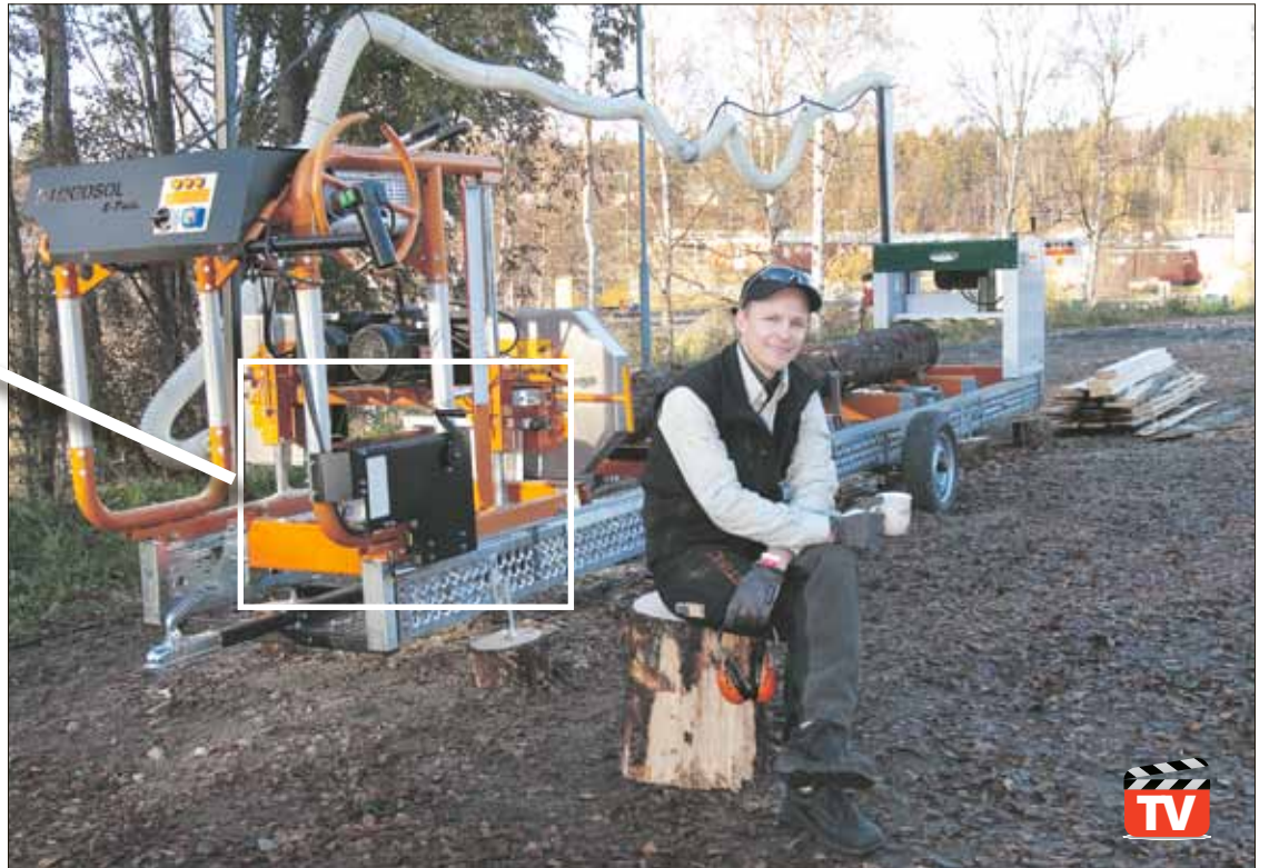
Den nya elmatningen till LM40. T h ett fullutrustat sågverk. Förutom matningen har det hjul för transport, timmerfräsen och spånsugningsutrustning. Vid kaffekoppen Mattias Byström som konstruerat matningen tillsammans med Jonas Höglund.
