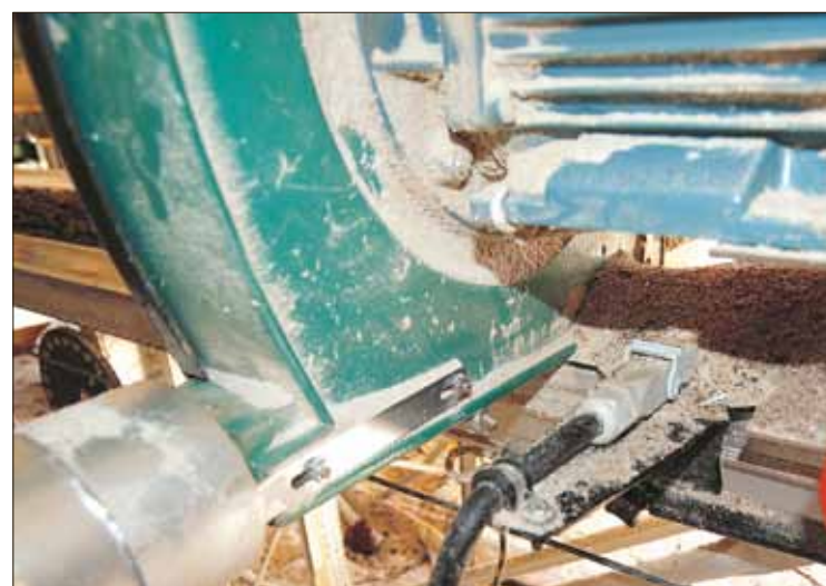
Rolf har monterat samma fästeanordning, den s k älgen, på bandsågen som finns på elsågarna och timmerfräsarna i utförande för elmatning.
