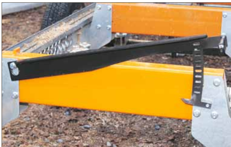
Ny topplyft till LM40, för gran och furu i normala dimensioner och ett bra hjälpmedel för att positionera och vända stockarna.
