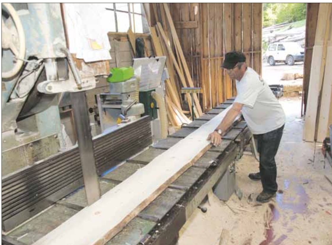
Jean Raynaud har två bandsågar, den ena för att sönderdela stockarna och den här används för att kanta och torrklyva. Fyrkutterhyveln är den minsta av maskinerna, men ändå den viktigaste.
