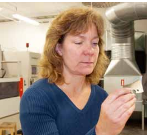
Maria Linder kontrollerar ett stål efter gnistning. Hela processen är mycket exakt och helt datorstyrd.
