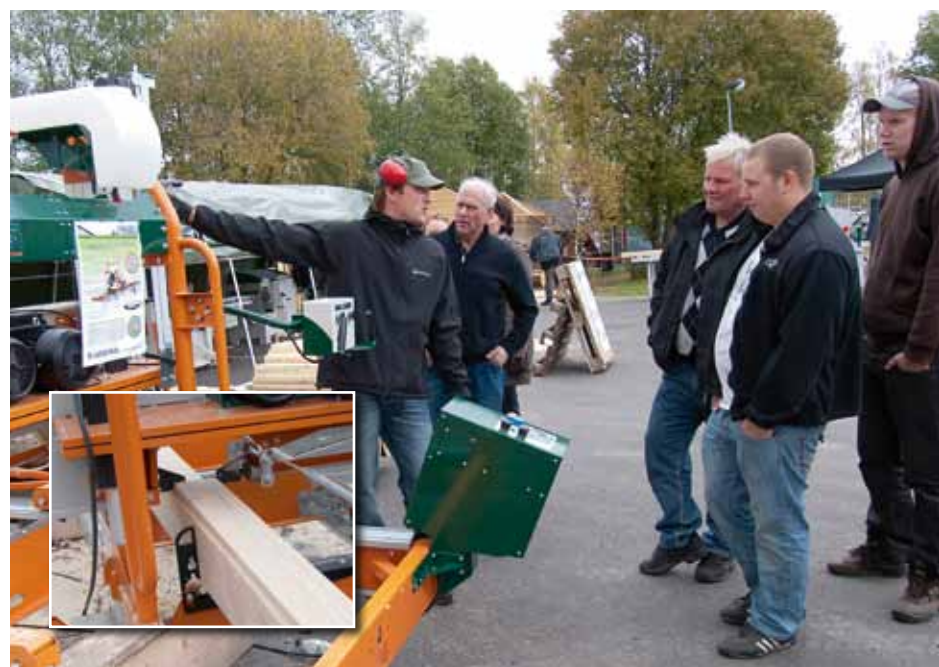
Logosols konstruktör Jonas Höglund demonstrerar den nya matningen till bandsågverket LM Pro. Infällda bilden: Klaffarna som fälls ut bakom sågbladet.
