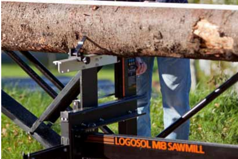
• Stocken lyfts med vinschar till bekväm arbetshöjd och hålls fast med kraftiga stockhållare.
