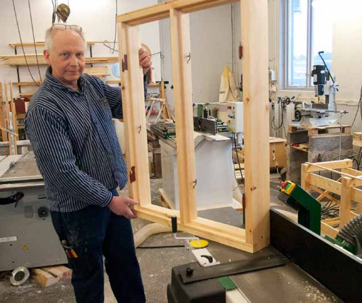
– Logosols planhyvel och vertikalfräsen MF30 är utmärkta maskiner för tillverkning av kvalitetsfönster, anser Per Blomqvist på OscarsHus AB.
