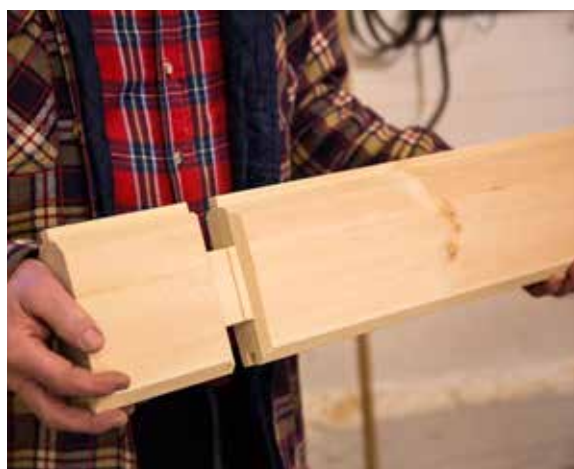
• Bert Ermander med timmer som just frästs i knutmaskinen. Passformen är perfekt.
