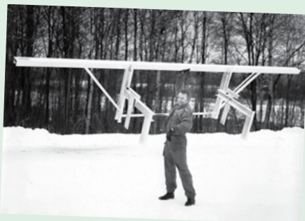
• Bengt-Olov Byström med Solosågen modell två, på en arm. Året var 1989. Ställningen vägde 37 kg utan motorsåg.
