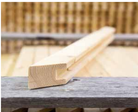
• Färdighyvlade fönsterbågar väntar på glasmontering.
