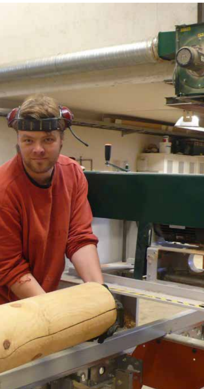
• I stort sett hela byggprocessen sker med maskiner från Logosol. Lars Ole Vesterheim kan hantera stockar upp till 7 meter.
