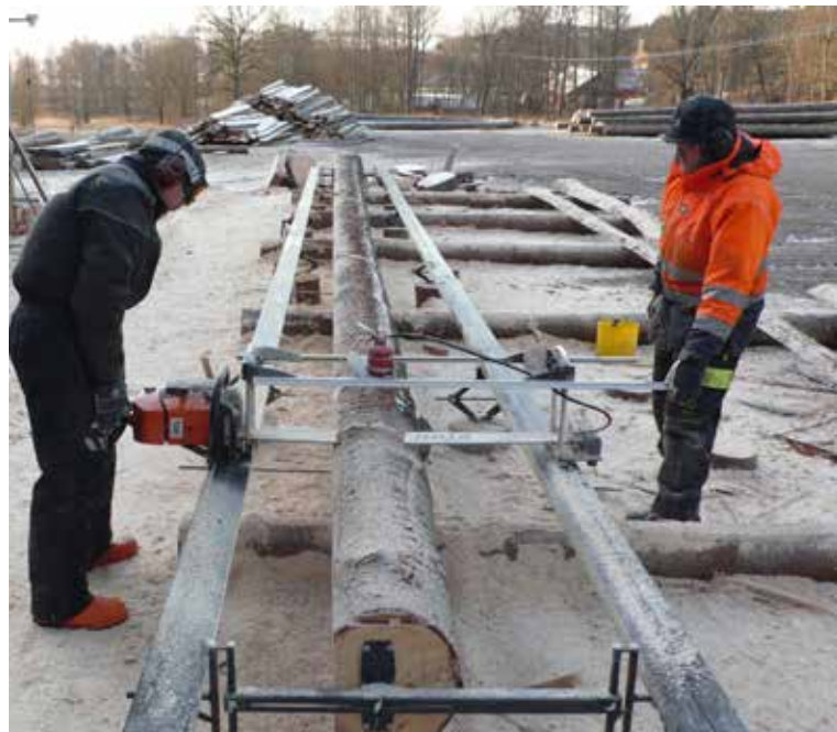
• För att klara sågningen krävdes en såganläggning avsedd för övergrova stockar.
