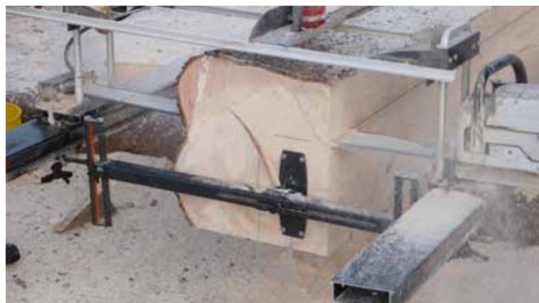
• I samråd med Logosol beställdes en Big Mill Pro med Stihl 880 och ett 1,30 meter långt svärd.
