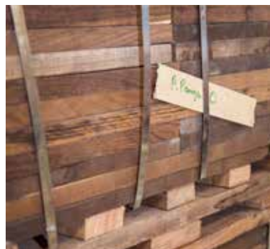
• Projektet inleddes med att sågverket i Mozambique skickade prover på olika afrikanska träslag, bland annat Panga Panga och Msasa. Berth Olsson har hyllat de hårda träslagen med Logosol fyrkutterhyvel och tagit fram en prototyp på ett golv med fiskbensmönster.
