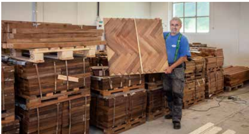
• Projektet inleddes med att sågverket i Mozambique skickade prover på olika afrikanska träslag, bland annat Panga Panga och Msasa. Berth Olsson har hyllat de hårda träslagen med Logosol fyrkutterhyvel och tagit fram en prototyp på ett golv med fiskbensmönster.
