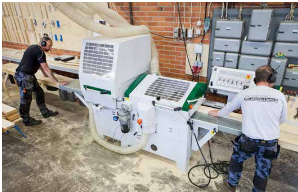
• Maskinparken från 60-talet kompletterades med maskiner från Logosol. PH365 femkutterhyvel klarar komplexa produktioner. "Vi måste vara flexibla och kunna leverera de produkter som våra kunder vill ha. Då måste vi också ha maskiner att lita på", säger Mattias Sedenberg om investeringen.
