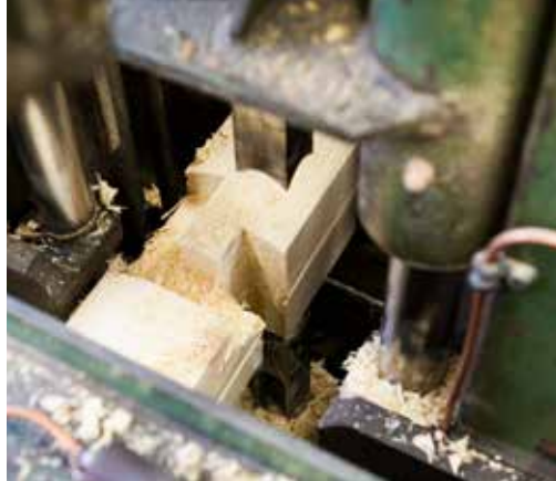
• En unik knutmaskin för Delsboknutar, lokalt tillverkad år 1962, tillhör maskinparkens rariteter.
