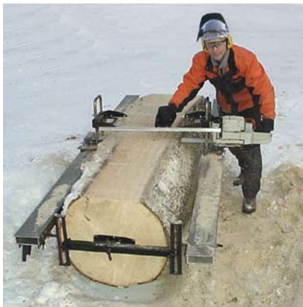
Big Mill PRO med dubbla linjaler, arm EXT och fästplatta EXT. Styrskenorna (nr.4 sid 27) vidrör ej stocken.
