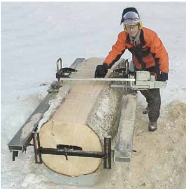
Big Mill PRO med dubbla linjaler, arm EXT och fästplatta EXT. Styrskenor (nr.4 sid 27) vidrör ej stocken.
